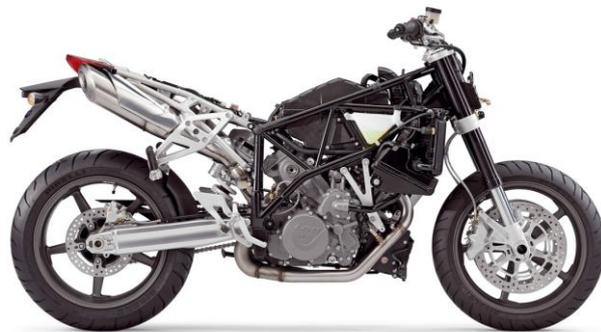
A ciclística é formada por quadro, suspensão, rodas, pneus e freios. Esta turma é quem dá estabilidade ao movimento gerado pela mecânica, além de ajudar a determinar o tipo de moto, de acordo com as características de ciclística.
