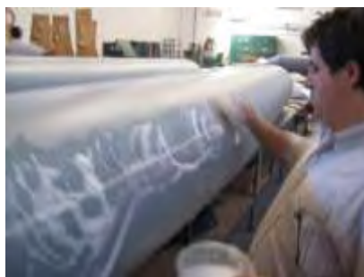
Teste de estanqueidade flutuador
