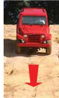
Alinhamento correto do Troller com a descida.
