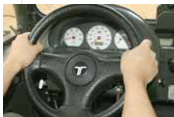
Segurando errado o volante em off-road.
