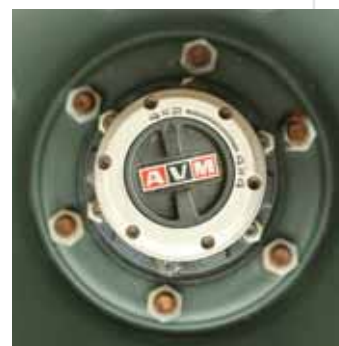
Roda-livre desengatada, permanece na posição 4x2.
