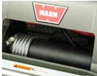
Ao acumular cabo em uma das laterais, retire e redistribua antes de concluir o resgate.
