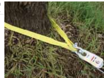
Detalhe da montagem da patesca na cinta.
