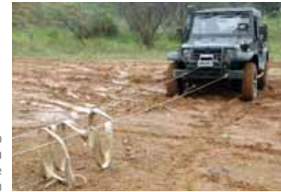
Cabo de aço esticado. coloque lastro em cima e evite acidentes caso haja rompimento do cabo ou do ponto de ancoragem
