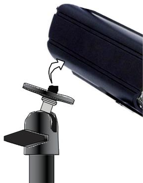
1. Para cada câmara, instale o suporte da câmara no parafuso de montagem. Pode instalar o suporte na parte superior ou inferior da câmara, conforme necessário. Aperte algumas voltas,
