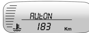
A autonomia exibe a distância aproximada que o veículo pode percorrer sem reabastecer. A estimativa da autonomia baseia-se no consumo médio de combustível do veículo no histórico recente de condução e na quantidade remanescente de combustível no tanque. A autonomia pode ser zerada mantendo o botão **R** pressionado durante dois segundos.
