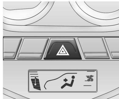
Pressione este botão localizado no painel de instrumentos próximo do sistema de controle de ventilação e ar condicionado, para fazer com que as luzes indicadoras dos sinalizadores de direção dianteiros e traseiros
