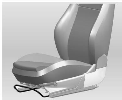
Para ajustar o banco para frente/para trás, puxe a alavanca de regulagem para cima, deslize o banco para a posição desejada e solte a alavanca travando-o.
