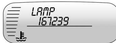
Esta mensagem é exibida se for preciso trocar uma das lâmpadas dos sinalizadores de direção.
