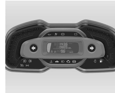
Podem ser visualizados no painel de instrumentos: o velocímetro, o tacômetro, medidor de combustível, temperatura do líquido de arrefecimento do motor, luzes das setas e luzes indicadoras.
