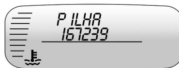
Esta mensagem é exibida quando a bateria do controle remoto precisa ser substituída.
