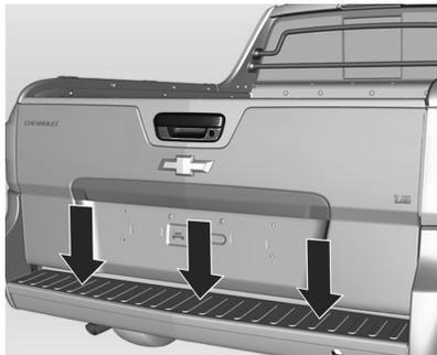
A carga máxima sobre o para-choque traseiro é de 100 kg.
