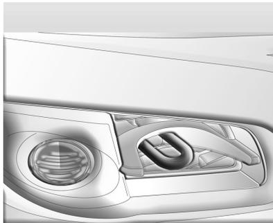
O gancho de emergência localiza-se na ponta frontal do veículo, no lado direito.
