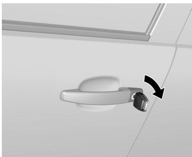
Gire a chave no sentido horário. Será acionado o travamento das portas e da tampa de acesso ao bocal de abastecimento do tanque de combustível. O alarme não está ativado e os vidros não fecharão se o veículo for travado com a chave.
