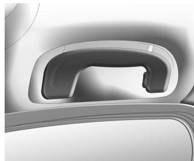
A maçaneta de segurança está presa no teto acima da porta do passageiro. Para usá-la puxe-a para baixo, ela retornará automaticamente para sua posição original após o uso.
