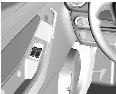
Em veículos equipados com vidros elétricos, o sistema é controlado por interruptores localizados nas respectivas portas. A disponibilidade de atuação é indicada pelas luzes nos interruptores:
