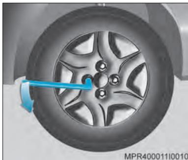
6. Com a chave de roda, afrouxe os parafusos 1/2 a 1 volta, mas não os remova.
