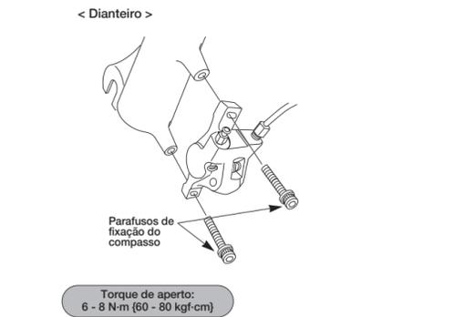
Pode-se usar um método de tampar ou de anel de arame para evitar que os parafusos se afrouxem. Use o método adequado ao garfo dianteiro e à estrutura.
