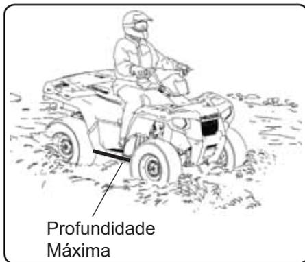
**AVISO:** Poderá ocorrer um dano grave ao motor se o veículo não for inspecionado completamente após a operação na água. Efetue os serviços descritos na tabela de manutenção. Veja a página 67. As seguintes áreas requerem atenção especial: óleo do motor, óleo da transmissão, fluido de tração sob demanda, óleo da caixa de marchas traseira e todos os pinos graxeiros.
