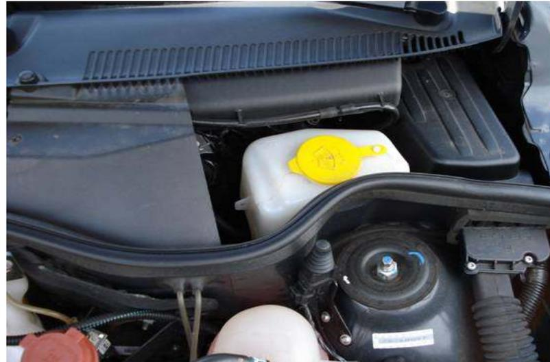
Quando completar o reservatório de água do limpador de pára-brisa, não esquecer de colocar o Aditivo, pois além de garantir a limpeza do pára-brisa, proporcionará maior vida útil às palhetas. Utilize um frasco a cada enchimento.
