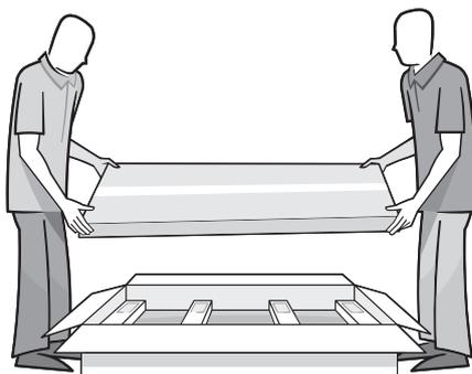
3. Retire a proteção do Piano Digital. Utilize as mãos para retirar a proteção do piano. Evite utilizar ferramentas que possam danificar o instrumento.
