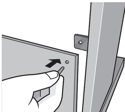
**3.** Alinhe corretamente os quatro furos da tampa de fundo com a tábua de sustentação dos pedais. Em seguida, instale os quatro parafusos 1/2" para a madeira e fixe-os bem. Aperte adequadamente todos os quatro parafusos e os dois parafusos pequenos.
