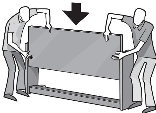
**2.** Alinhe os furos com os buracos específicos do suporte lateral do teclado. Utilize os dois parafusos de 1/2" (pequenos). Não aperte definitivamente os parafusos, apenas coloque-os e fixe-os perfeitamente às partes do gabinete.
