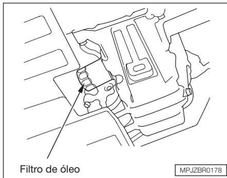
3. Remova o filtro de óleo e deixe drenar o óleo remanescente. É necessária uma chave especial para remover o filtro de óleo.
