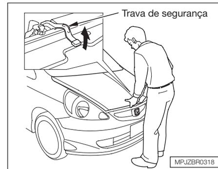
2. Posicione-se em frente ao veículo, coloque os dedos entre o capô e a grade dianteira. A trava de segurança do capô está localizada logo acima do emblema da Honda (“H”). Pressione esta trava para cima, até ela tocar no capô. Levante o capô.
