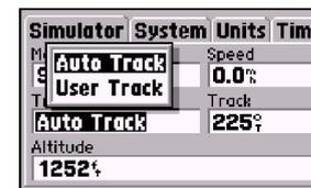
O ajuste 'Track Control' permite que o simulador 'alinhe' automaticamente no rumo correto para um waypoint de destino.
