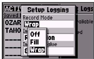
'Wrap' substituirá a trilha registrada anteriormente na memória, assim que a memória tiver sido totalmente usada. 'Fill' gravará os dados até que a memória esteja cheia, e interromperá a gravação.
