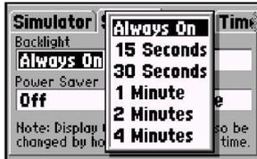
Defina o campo 'Backlight' como 'Always On' para impedir que a iluminação de fundo se apague automaticamente após o intervalo pré-definido.
