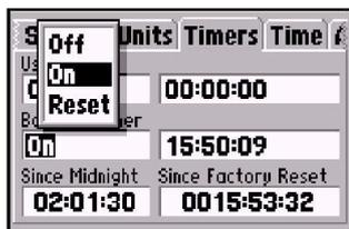
O contador de tempo de uso da bateria será automaticamente resetado quando as pilhas gastas forem substituídas
