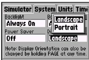
A orientação da tela é ajustável pressionando-se e mantendo-se pressionada a tecla PAGE, ou a partir dos ajustes do sistema (System).
