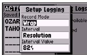
A opção 'Setup Logging' permite modificar os critérios usados para gravar o registro de trilha ativo.
