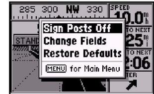
A opção ‘Sign Posts Off’ permite que sejam removidas as marcas dos waypoints do gráfico da estrada.
