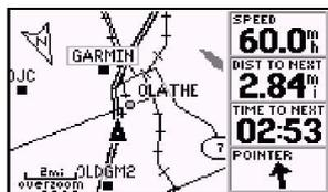
Na orientação de 'Track Up' o mapa é automaticamente girado para manter a direção atual de deslocamento na parte superior da tela. Note que o indicador está na parte superior na tela.
