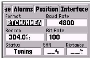
Selecione a opção 'RTCM/NMEA' para utilizar o GPS III+ junto com um Receptor Diferencial de Radiofarol.
