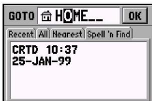
Pressione ENTER e use o teclado basculante para inserir o identificador do waypoint de destino. Pressione ENTER novamente para confirmar o waypoint e iniciar a navegação
