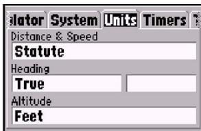
Para visualizar a informação desejada, selecione a etiqueta apropriada (usando as teclas LEFT/RIGHT do teclado basculante).
