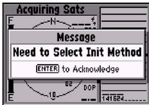
Segure o receptor em uma posição confortável com a antena apontando para cima. Quando nova (ou se a posição não pode ser determinada após 10 min) o GPSIII+ lhe pedirá para inicializar o receptor. A unidade necessita uma posição inicial para determinar quais satélites estão à vista.
