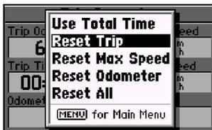
O odômetro de viagem, cronômetro de viagem e leituras de média de velocidade podem ser zeradas na Opção de 'Trip Computer' na Menu principal
