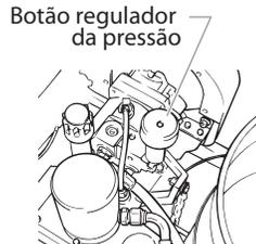
4. Abra a válvula de fechamento hidráulica situada no tubo de pressão hidráulico. O manípulo deve estar alinhado com o tubo.
