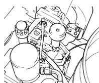
4. Abra a válvula de fechamento hidráulica situada no tubo de pressão hidráulico. O manípulo deve estar alinhado com o tubo.
