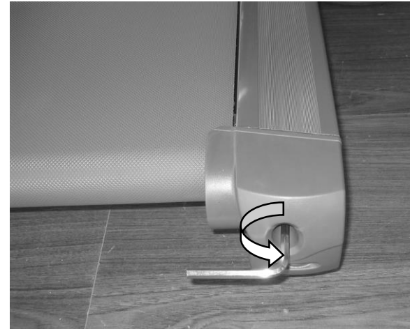
Gire no sentido anti-horário para diminuir a tensão da lona
