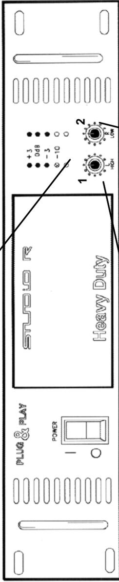
O controle (1) da esquerda L(HIGH), ajusta a potência do canal esquerdo. Para fazer isto com precisão consulte o manual do módulo ADL
