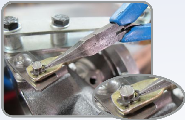
Retirar com um alicate a trava de segurança.
