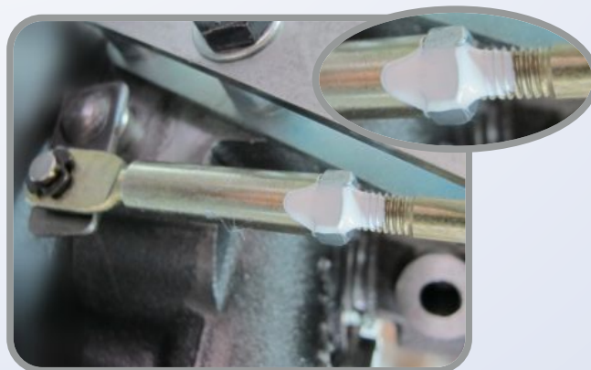
Aplicar um marcador na porca sextavada para que o turbo não seja alterado.
