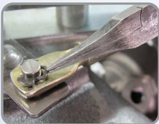
Colocar novamente a trava de segurança.
