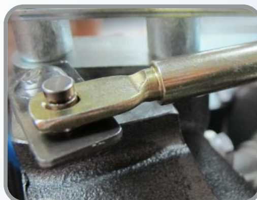
Colocar de volta a haste da válvula no braço.
