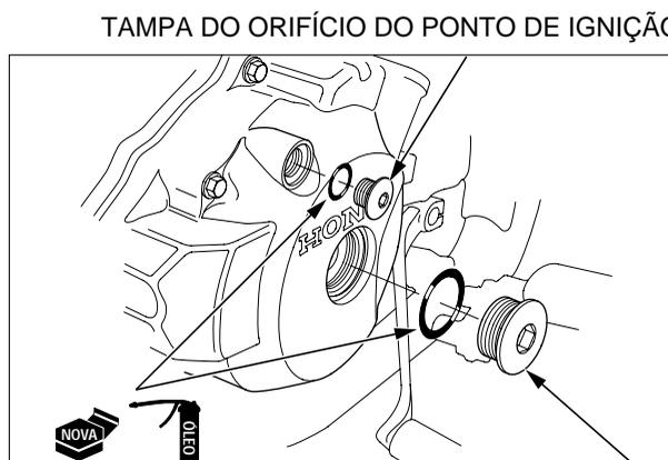
TAMPA DO ORIFÍCIO DO PONTO DE IGNIÇÃO
