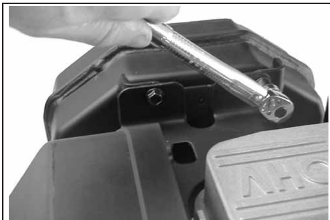
Figura 11-63. Instalar o Suporte Superior do Silenciador e os Parafusos de Montagem.
