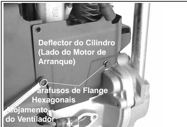
Figura 11-40. Instalar o Deflector do Cilindro (Lado do Motor de Arranque).
