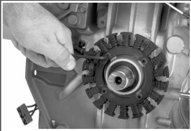
Figura 9-40. Retirar o Estator.
