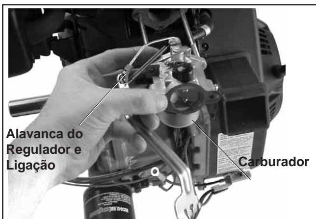
Figura 9-11. Retirar o Carburador e a Alavanca do Regulador.
