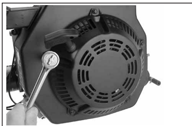
Figura 7-2. Retirar o Motor de Arranque Retráctil.
