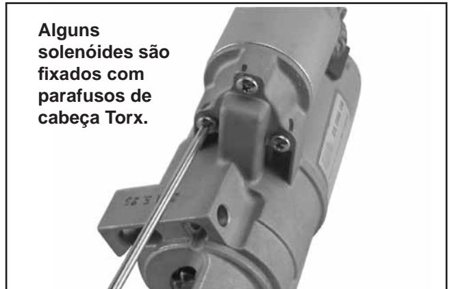
Figura 8-30. Retirar os Parafusos do Solenóide.
