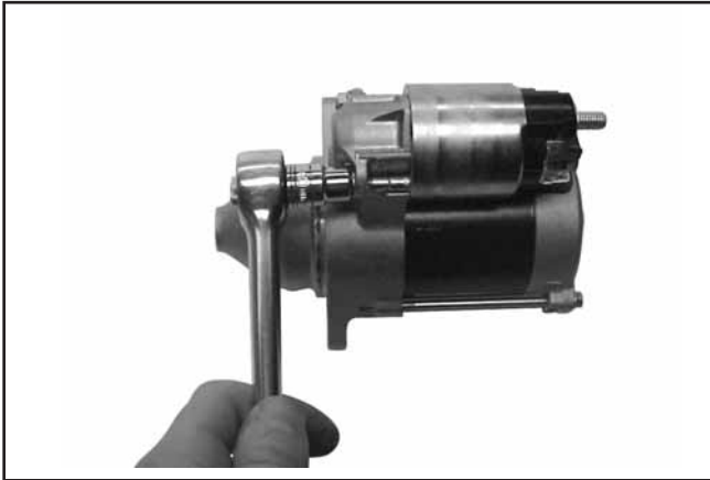
Figura 8-27. Instalar o Solenóide.
