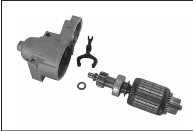
Figura 8-37. Armadura e Alavanca Retiradas.
