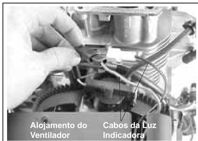
Figura 11-39. Ligar os Cabos da Luz Indicadora do Oil Sentry™.
