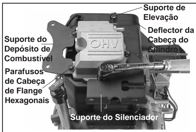
Figura 11-44. Instalar a Tampa da Válvula. (Tampa de Fundição/Alumínio Mostrada).
