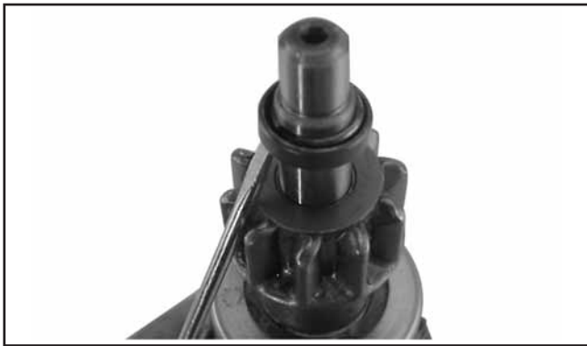
Figura 8-45. Instalar o Colar Batente/Retentor.
