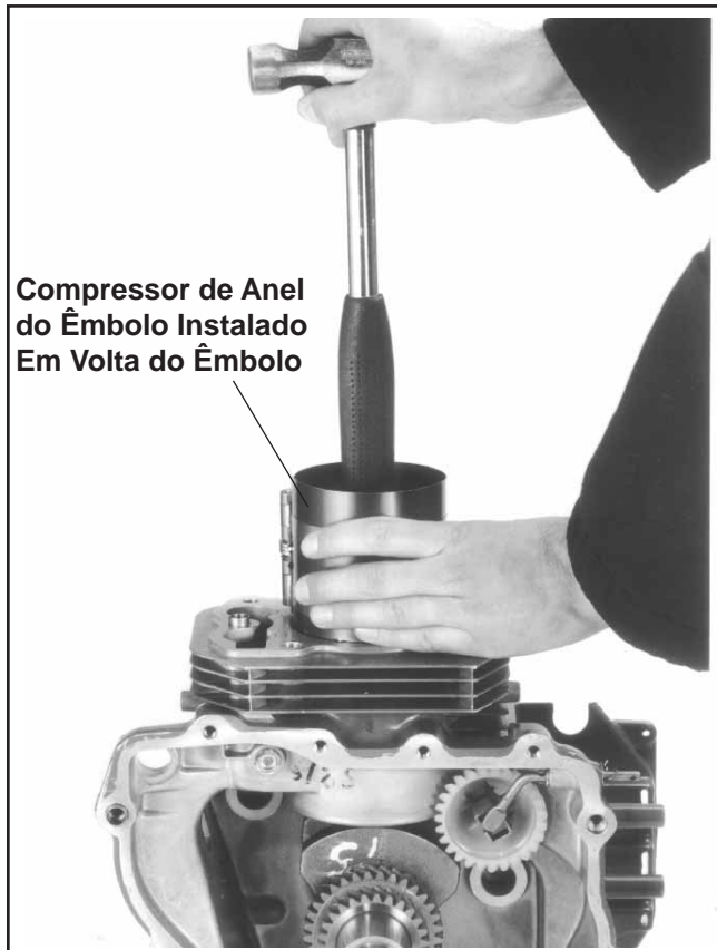
Figura 11-6. Instalar o Êmbolo e a Biela.
