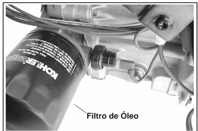
Figura 6-5. Filtro de Óleo e o Oil Sentry™.
