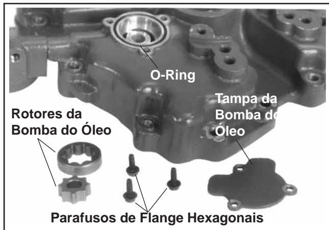
Figura 9-46. Retirar a Bomba do Óleo.
