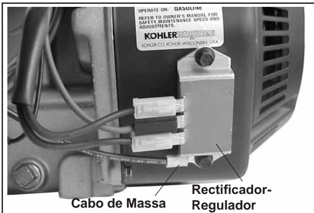
Figura 11-52. Instalar o Rectificador-Regulador.
