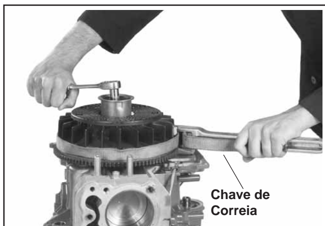
Figura 9-37. Retirar o Parafuso de Retenção do Volante do Motor e a Taça de Accionamento.
