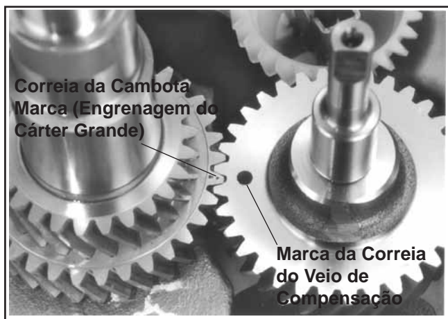
Figura 11-10. Alinhar as Marcas da Correia na Engrenagem do Cárter e a Engrenagem do Veio de Compensação.
