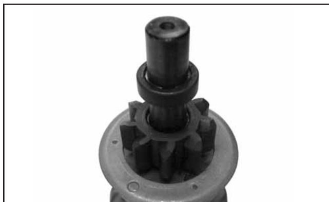
Figura 8-20. Colar de Bloqueio em volta do Anel de Retenção.
