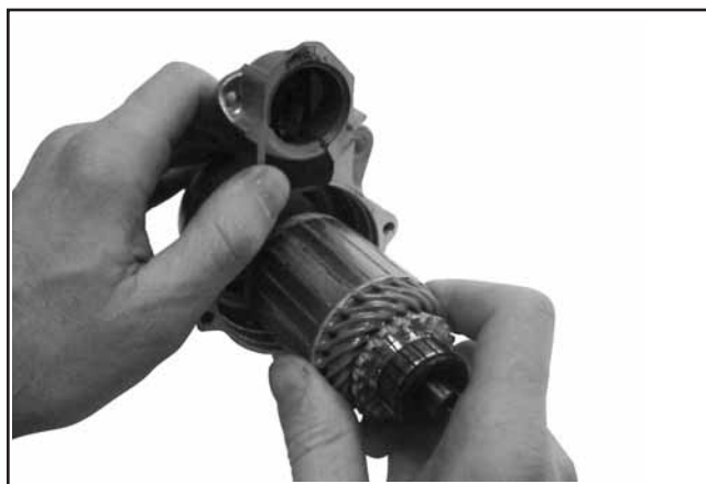
Figura 8-21. Instalar a Armadura.
