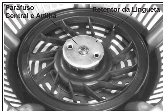
Figura 7-5. Parafuso Central, Anilha e Retentor da Lingueta.
