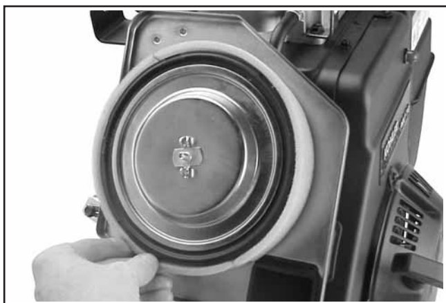
Figura 11-59. Instalar o Filtro de Ar.
