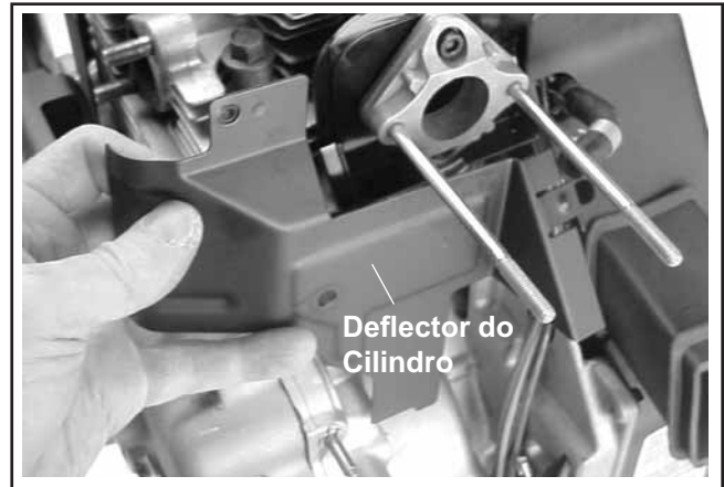
Figura 9-24. Retirar o Deflector do Cilindro do Lado da Admissão
