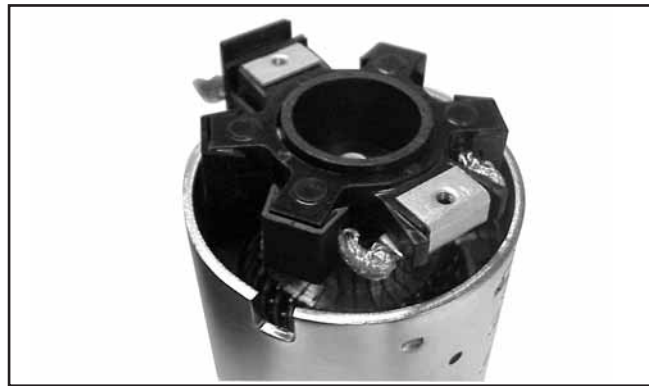
Figura 8-51. Instalar o Conjunto do Suporte da Escova com o Tubo Protector.
