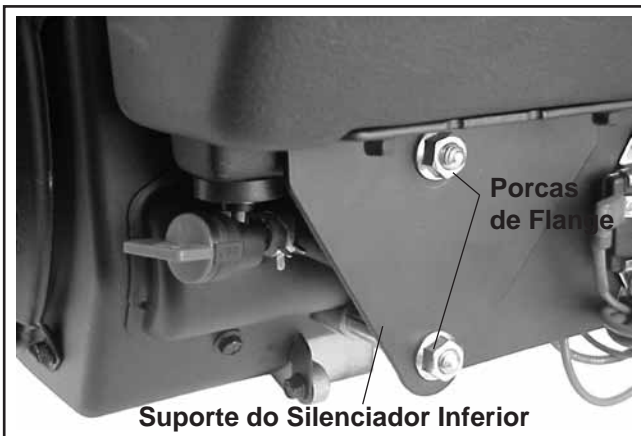
Figura 11-51. Instalar as Porcas de Montagem Inferiores do Depósito de Combustível.
