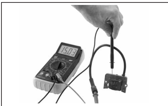
Figura 8-4. Testar o Módulo Secundário.
