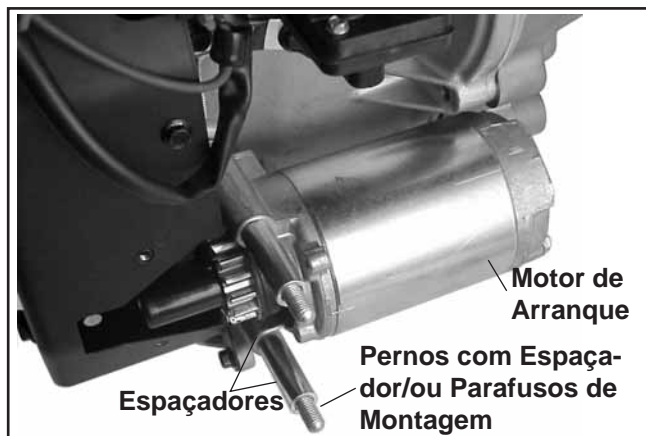
Figura 11-47. Instalar o Motor de Arranque Eléctrico.
