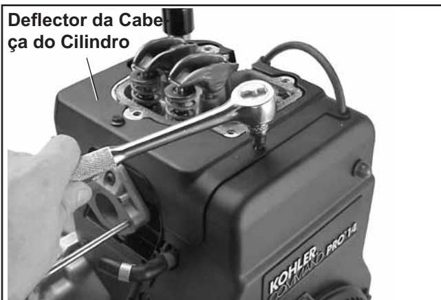
Figura 9-23. Retirar o Deflector da Cabeça do Cilindro.
