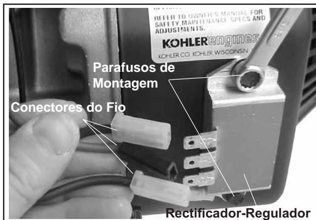
Figura 9-20. Retirar o Rectificador-Regulador.
