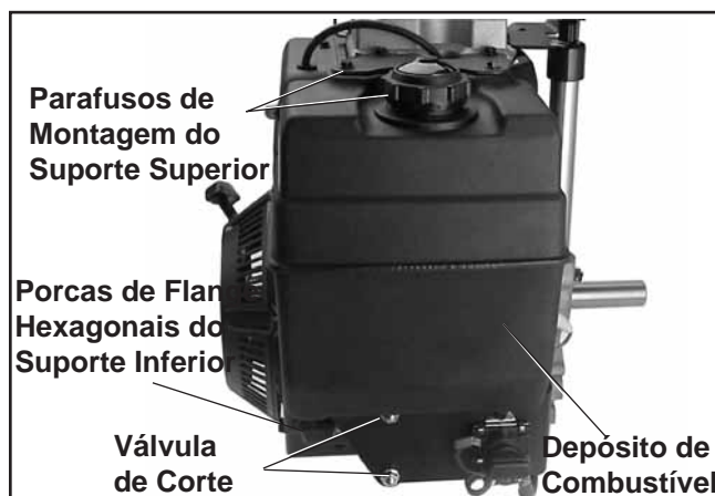
Figura 9-12. Retirar o Depósito de Combustível.
