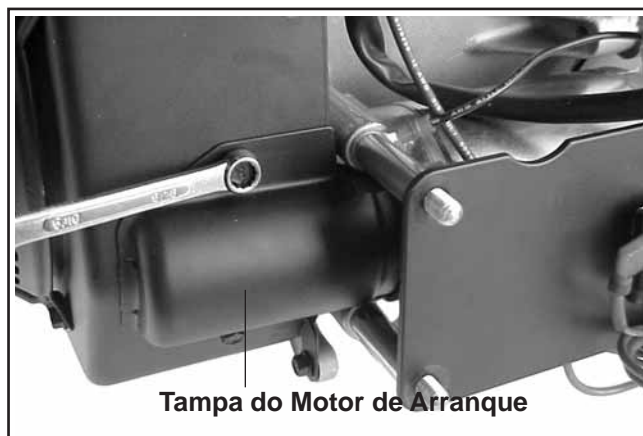
Figura 11-49. Instalar a Tampa do Motor de Arranque.
