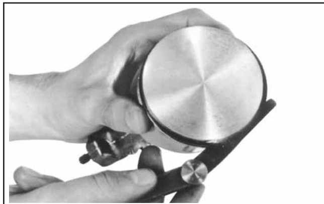
Figura 10-7. Medir a Folga Lateral do Anel do Êmbolo.
