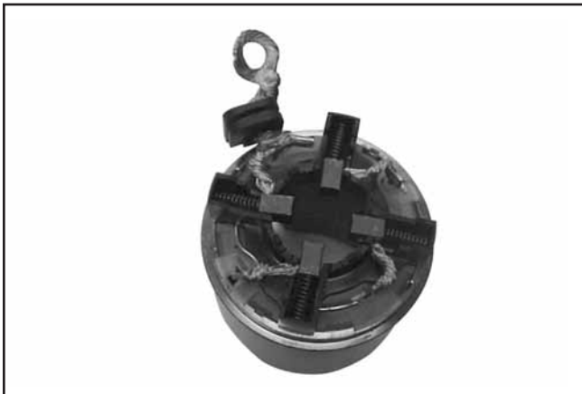
Figura 8-22. Montar o Suporte da Escova na Estrutura.
