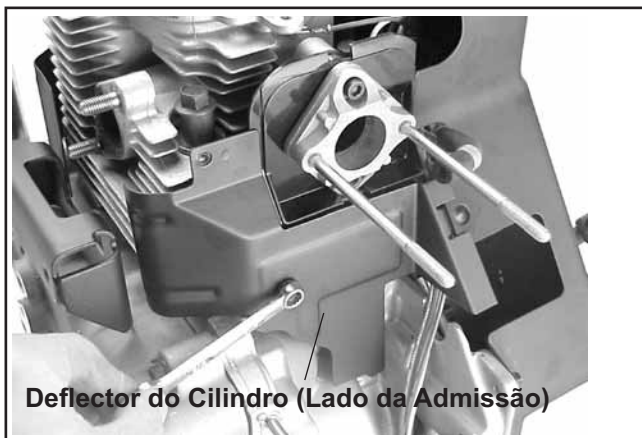
Figura 11-41. Instalar o Deflector do Cilindro (Lado da Admissão).
