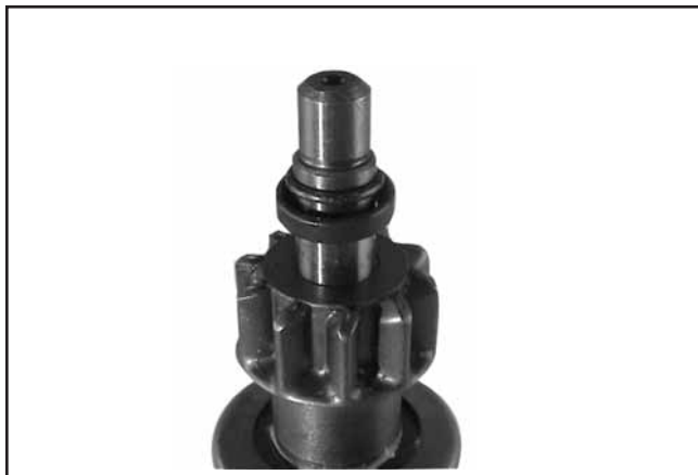
Figura 8-38. Pormenores do Anel de Retenção.
