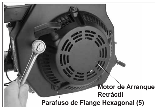
Figura 9-13. Retirar o Motor de Arranque Retráctil.
