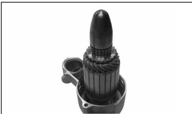
Figura 8-24. Ferramenta na Extremidade da Armadura.
