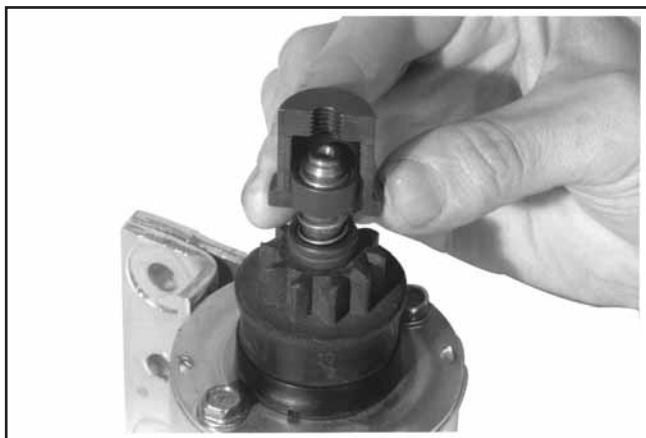
Figura 8-14. Montar a Metade Interior Maior Em Volta do Retentor da Mola.
