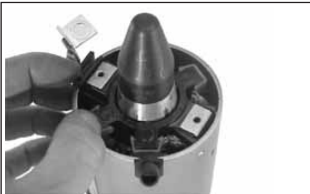
Figura 8-54. Utilizar a Ferramenta de Instalação com Extensão.
