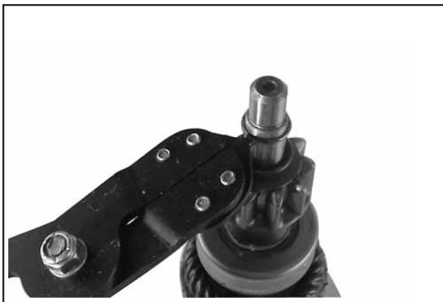
Figura 8-39. Remover o Anel de Retenção.
