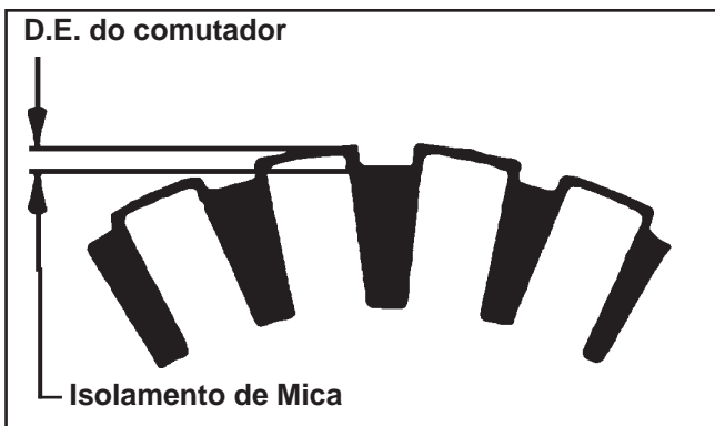
Figura 8-41. Inspeção da Mica do Comutador.
