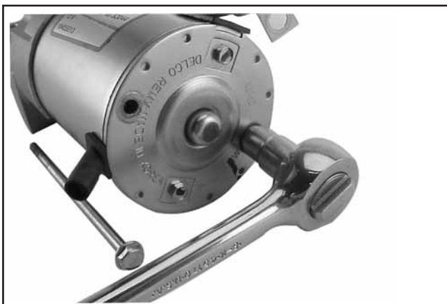
Figura 8-33. Retirar os Parafusos de Impulso.
