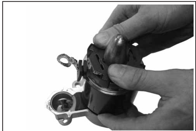
Figura 8-25. Instale a Estrutura com o Conjunto da Placa da Escova.
