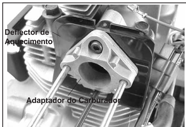
Figura 11-38. Instalar o Adaptador do Carburador e o Aquecimento.
