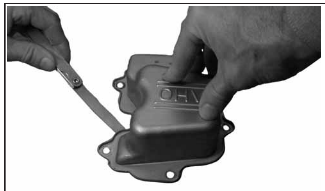
Figura 10-11. Verificar com Apalpa-folgas.
