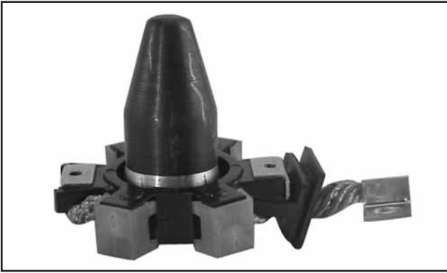
Figura 8-53. Ferramenta de Instalação da Escova com Extensão.
