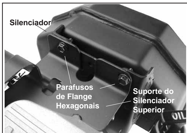
Figura 9-2. Retirar o Amortecedor.
