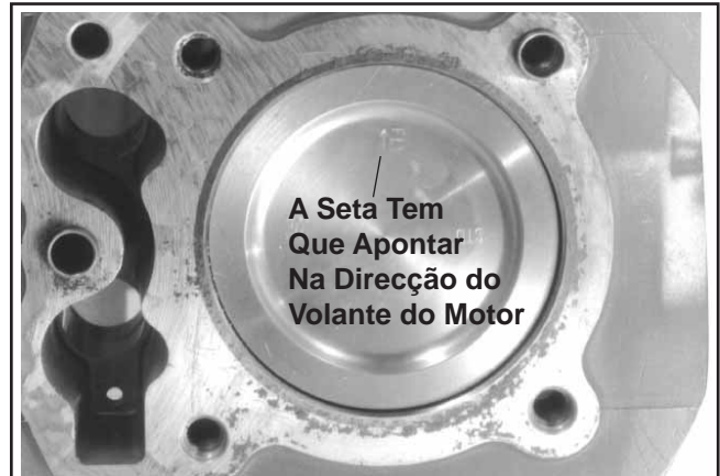
Figura 11-7. Identificador de Instalação do Êmbolo.
