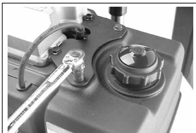
Figura 11-50. Instalar os Parafusos de Montagem Superiores do Depósito de Combustível.
