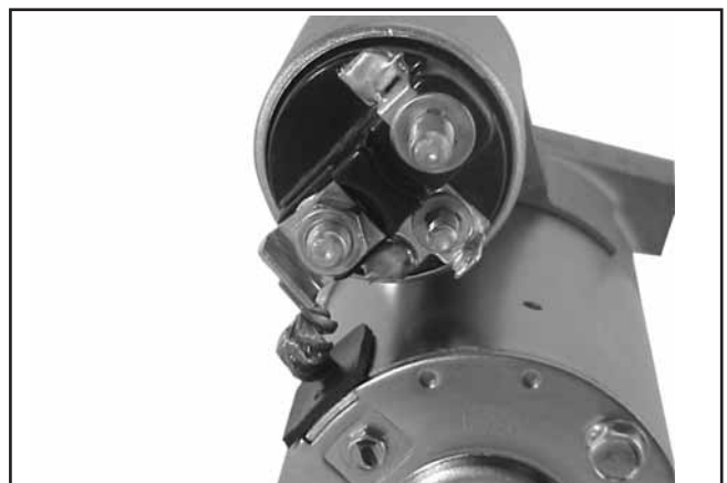
Figura 8-57. Ligação do Cabo da Escova Positivo (+).
