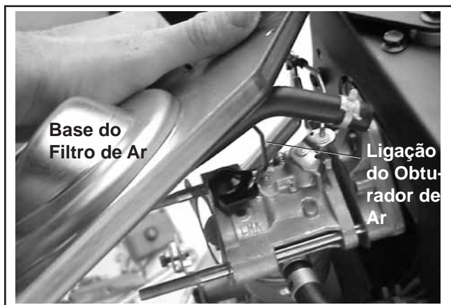
Figura 11-56. Ligar a Ligação de Obturador.
