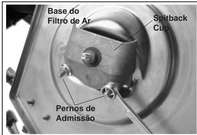
Figura 9-6. Retirar a Taça e a Base do Filtro de Ar.
