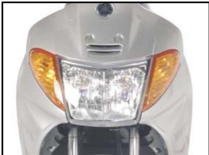
O farol multi-refletor é parte integrante da carenagem frontal. Fornece uma luz ampla, aumentando o alcance de visão do piloto e a visibilidade da motocicleta para uma pilotagem mais segura.
