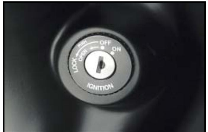
Para acessar o compartimento para capacete que fica embaixo do banco, gire a chave de ignição conforme mostrado nas fotos ao lado: girando a chave para a esquerda sem empurrá-la como se fosse travar o guidão.
