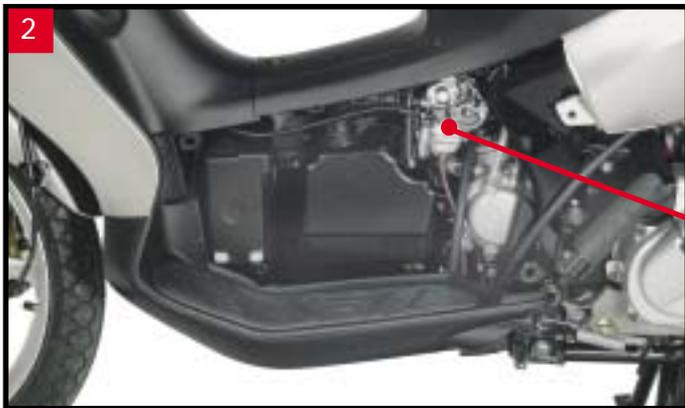
2. Retirar a carenagem dianteira esquerda da moto. Lubrificar a articulação do carburador e ajustar a folga do cabo do acelerador, deixando a folga na manopla do acelerador de acordo com a especificação.
