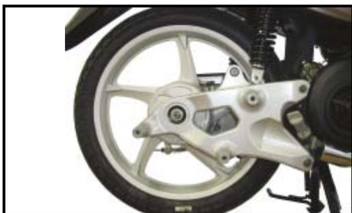
4. Solte a fixação inferior do amortecedor e desloque o amortecedor para frente.
