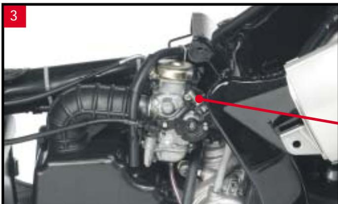
3. Girar o parafuso regulador da marcha-lenta do acelerador no sentido horário a fim de aumentar a rotação do motor e no sentido anti-horário para reduzi-la. Ver a foto ③ para uma visão mais detalhada. Para um melhor ajuste, utilize um tacômetro digital.
