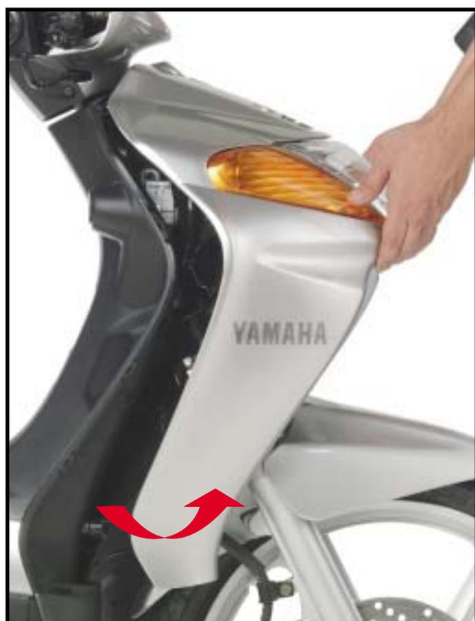
2. Desencaixar as garras nas extremidades da carenagem frontal. Remova a carenagem frontal de baixo para cima, apoiando a parte inferior do farol.
