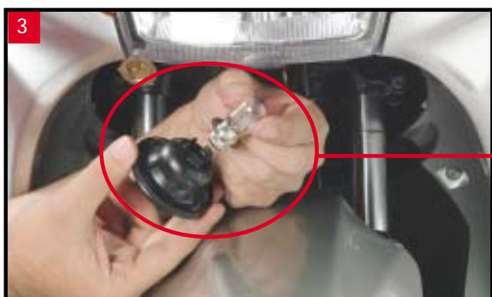
3. Segurar a lâmpada do farol pela garra existente na capa do farol e puxe para fora (ver foto ③). Inverter o procedimento acima para instalar a nova lâmpada. Segurar a lâmpada nova apenas pelo bocal.
