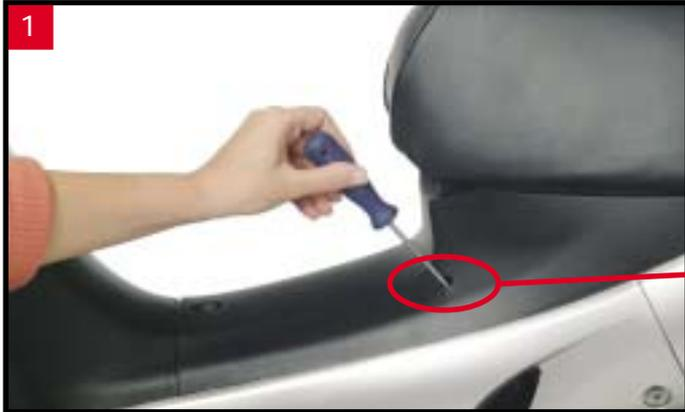
1. Retirar a tampa da carenagem central próxima ao parafuso regulador da marcha-lenta. O parafuso poderá agora ser acessado pelo furo. Não será necessário retirar a carenagem da moto.
