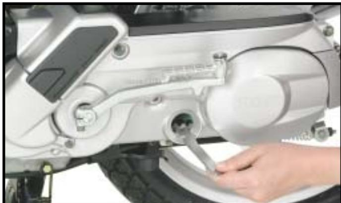
1. Remover o bujão de inspeção da tampa da caixa da correia e inserir o medidor de espessura na correia em V.
