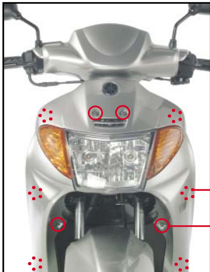
1. Retirar os dez parafusos da carenagem frontal, conforme indicado.
