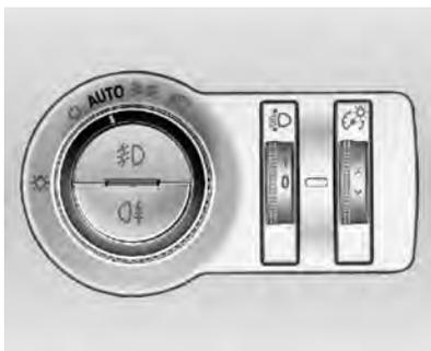
Quando a função de iluminação automática **AUTO** for ligada, o sistema liga automaticamente os faróis dianteiros e as lanternas traseiras, dependendo das condições de iluminação externa. Esta função opera com um pequeno retardo, dependendo das condições de iluminação.
