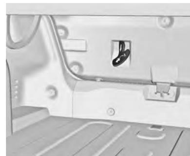
Localizada no interior do compartimento traseiro, perto da trava da tampa do mesmo, está a alavanca de liberação do compartimento traseiro de emergência. Ela pode ser usada para abrir o compartimento traseiro em casos de emergência.
