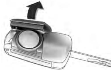
Estenda a chave e abra a unidade. Substitua a bateria (tipo de bateria CR 2032), prestando atenção à posição de instalação. Feche a unidade e sincronize.
