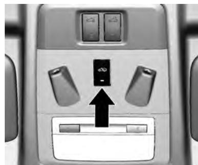
Desligue o monitoramento do compartimento de passageiros e de inclinação do veículo quando deixar animais no veículo, devido ao grande volume de sinais ultrassônicos ou movimentos que podem disparar o alarme. Também desligue-o quando o veículo estiver em uma barca ou trem.
