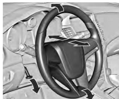
Destrave a alavanca, ajuste o volante e trave-a novamente, e assegure-se de que está totalmente travada. Regule o volante apenas quando o veículo estiver parado e a coluna de direção destravada.
