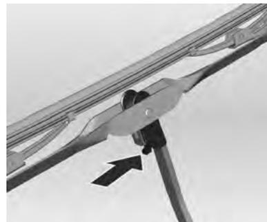
Levante a haste do limpador. Pressione a porca de travamento, puxe a palheta para baixo e remova-a.
