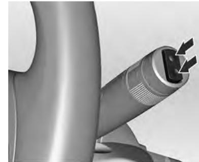
Pressione o interruptor de duas posições para ativar o lavador do vidro traseiro:
