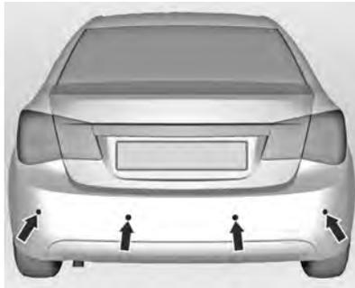
O sensor de estacionamento facilita o estacionamento medindo a distância entre o veículo e obstáculos traseiros, e fornecendo sinais sonoros. É o motorista, no entanto, que tem total responsabilidade pela manobra de estacionamento.
