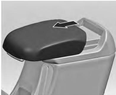
Pressione a alavanca para deslizar o apoio de braço.
