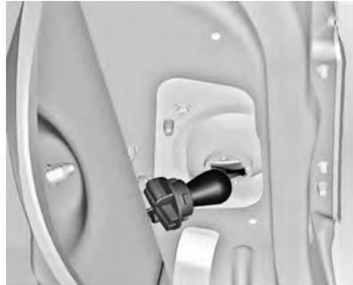
3. Remova o suporte da lâmpada. Empurre a lâmpada ligeiramente para dentro do soquete, gire no sentido anti-horário, remova-a e troque-a.
