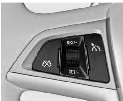
As chaves de controle de velocidade de cruzeiro se localizam no raio esquerdo da direção.
