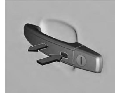
Pressione o interruptor na maçaneta da porta para destravar o veículo e puxe a maçaneta para abrir a porta, ou pressione o botão sob a tampa do porta-malas para abri-la.
