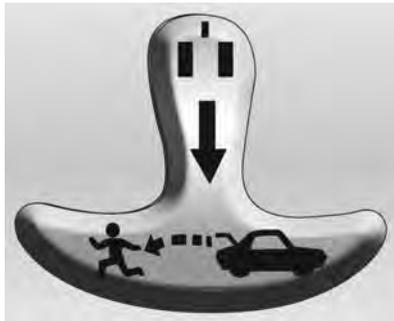
Puxe a alavanca de emergência para abrir o compartimento traseiro pelo interior do veículo.
