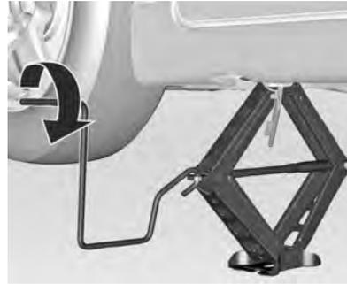
4. Conecte a alavanca e, com o macaco corretamente alinhado, gire-a até que o pneu se erga do chão.
