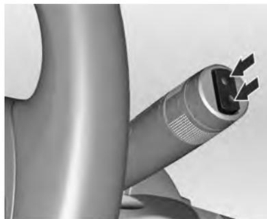
Pressione o interruptor de duas posições para ativar o limpador do vidro traseiro:
