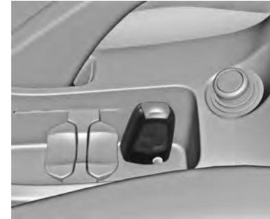
Abra a tampa na parte inferior do porta-copos, no console central. Desdobre a parte da chave eletrônica e insira-a conforme mostrado na figura.
