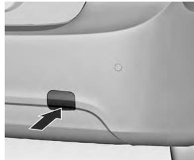
O orifício para instalar o gancho de emergência traseiro fica localizado no para-choque traseiro do veículo (lado direito).
