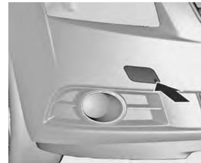
O orifício para instalar o gancho de emergência dianteiro fica localizado no para-choque dianteiro do veículo (lado direito).
