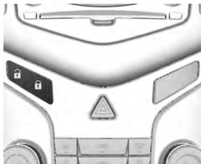
Trava ou destrava todas as portas, o compartimento de carga e a portinhola do bocal de abastecimento do tanque de combustível.
