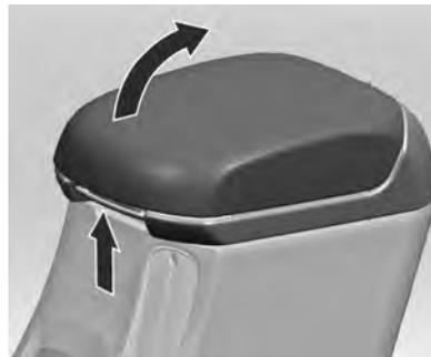
Empurre a alavanca para deslizar e dobrar o apoio de braço.
