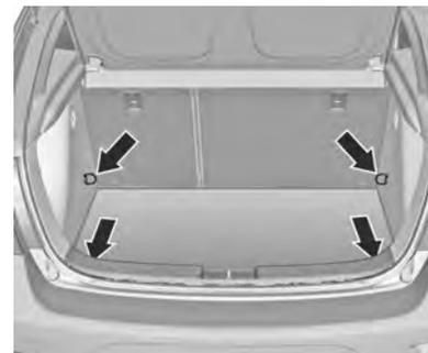
Os ganchos de fixação de carga foram projetados para prender os itens contra deslizamento, por exemplo, usando faixas ou rede de bagagem.
