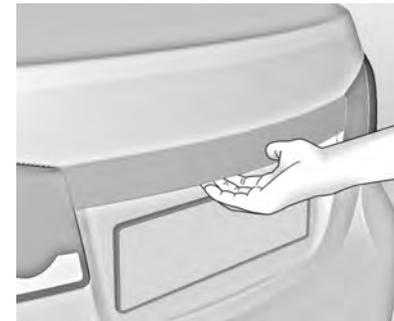
Depois de destravar, pressione o botão sob a guarnição da tampa do compartimento de carga ou o botão
