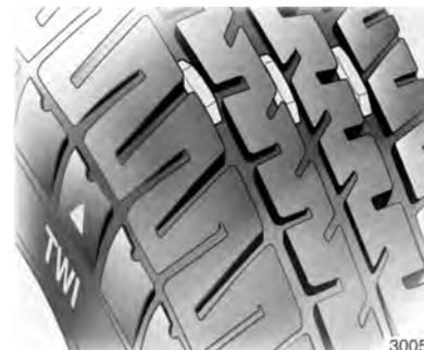
A profundidade mínima legalmente permissível da banda de rolagem (1,6 mm) foi alcançada quando a banda ficar desgastada até um dos indicadores de desgaste (TWI). Suas posições são indicadas por marcas na parede lateral.
