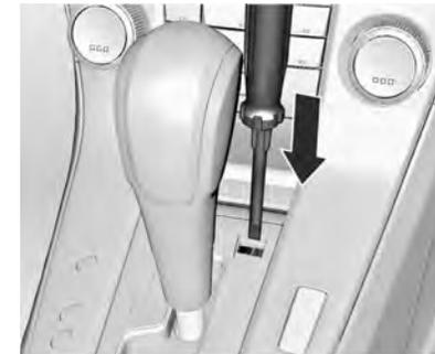
3. Insira uma chave de fenda na abertura até o ponto onde ela alcançar e mova a alavanca seletora da posição **P**. Se **P** for engatada de novo, a alavanca seletora ficará bloqueada na posição novamente. Dirija-se à Rede de Concessionárias ou Oficinas Autorizadas Chevrolet o mais rápido possível para verificar e reparar.
