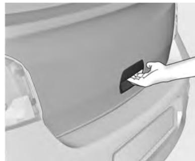
Após destravar as portas, pressione o botão abaixo da maçaneta e abra a tampa do compartimento de carga.
