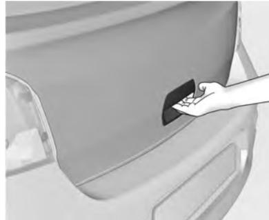
Após destravar, pressione o botão abaixo da maçaneta e abra a tampa do compartimento de carga.
