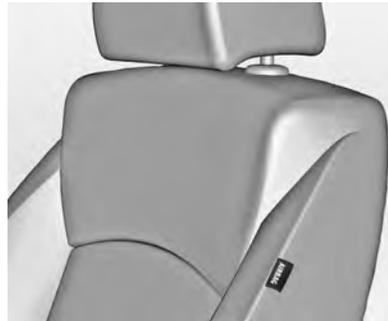
O sistema de Airbag lateral consiste em um Airbag no encosto de cada banco dianteiro. Ele pode ser identificado pelas palavras **SRS SIDE AIRBAG**.
