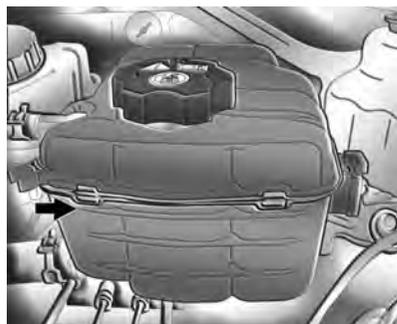
Se o sistema de arrefecimento estiver frio, o nível do líquido de arrefecimento deverá estar próximo à marca mostrada na figura. Caso o nível esteja abaixo dela, aguarde até que o sistema de arrefecimento esteja frio, remova a tampa do
