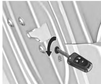
Usando uma chave ou uma chave de fenda adequada, gire as travas de segurança das portas traseiras para a posição horizontal. As portas não abrem pelo lado interno. Para desativação, gire as travas de segurança para a posição vertical.
