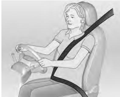
Ajuste a altura para que o cinto fique sobre o ombro. Ele não deve ficar sobre a garganta nem o braço. Não ajuste ao dirigir.
