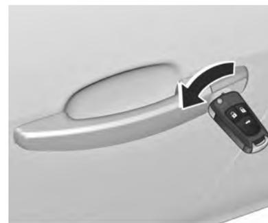
Destrave manualmente a porta do motorista ao girar a chave na fechadura. Ligue a ignição e pressione o botão de travamento central
