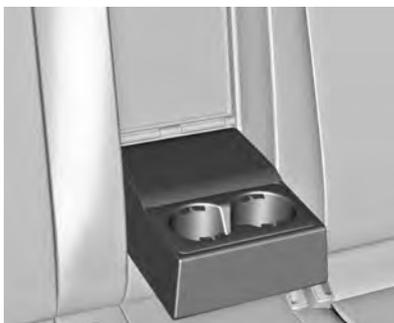
Dobre o apoio de braço puxando a faixa. O apoio de braço dobrado contém suportes para copo.
