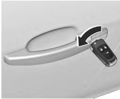
Destrave manualmente a porta do motorista ao girar a chave na fechadura. Ligue a ignição e pressione o botão de travamento central
