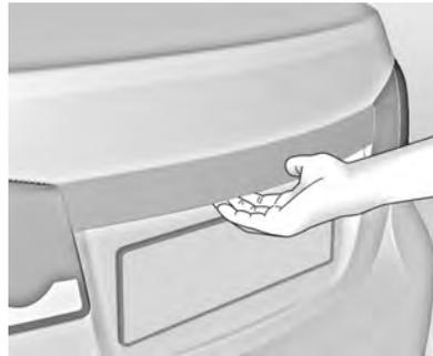
Depois de destravar as portas, pressione o botão sob a guarnição da tampa do compartimento de carga ou o botão
