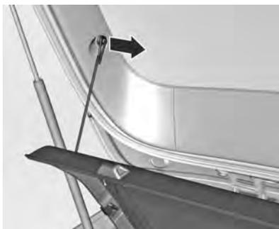
Desenganche as cintas de fixação da tampa do compartimento de carga.
