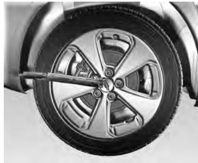
Dobre a chave de roda e instale-a assegurando-se de que ela esteja assentada de forma segura e afrouxe cada parafuso meia volta.
