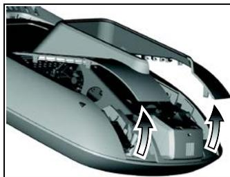
**Figura 24: Remoção da tampa de acesso do console P80**
