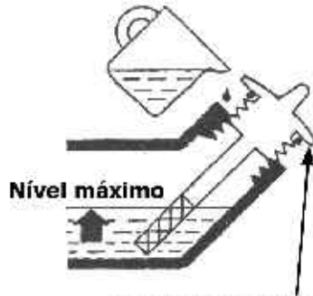
Medidor de nível de óleo
