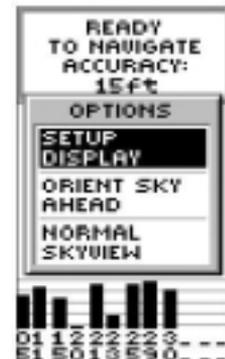
Pressionando-se ENTER na Página Advanced Skyview (Visão Avançada do Céu), obtém-se acesso às opções de Orientar o Céu para Frente ou para o Norte (ORIENT SKY AHEAD ou NORTHWARD). Também se pode configurar a tela (SETUP DISPLAY) quanto à iluminação de fundo e ao contraste, e voltar à Visão Normal do Céu (NORMAL SKYVIEW).
