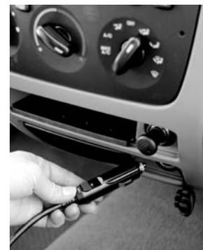
3. A ficha deve ser introduzida na tomada sem força excessiva e permanecer firmemente no devido lugar. O adaptador para isqueiro de carro é fornecido com um interruptor deslizante previamente regulado na posição "estreita". Nesta posição, o adaptador cabe na maior parte das tomadas de isqueiro de carro. Se o adaptador para isqueiro de carro estiver demasiado solto na tomada, regule o interruptor para a posição "ampla".
