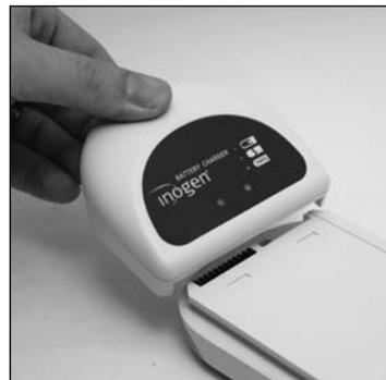
**PRECAUÇÃO** Evite tocar nos contactos eléctricos incorporados no carregador de baterias externo; danos nos contactos podem afectar o funcionamento do carregador.
