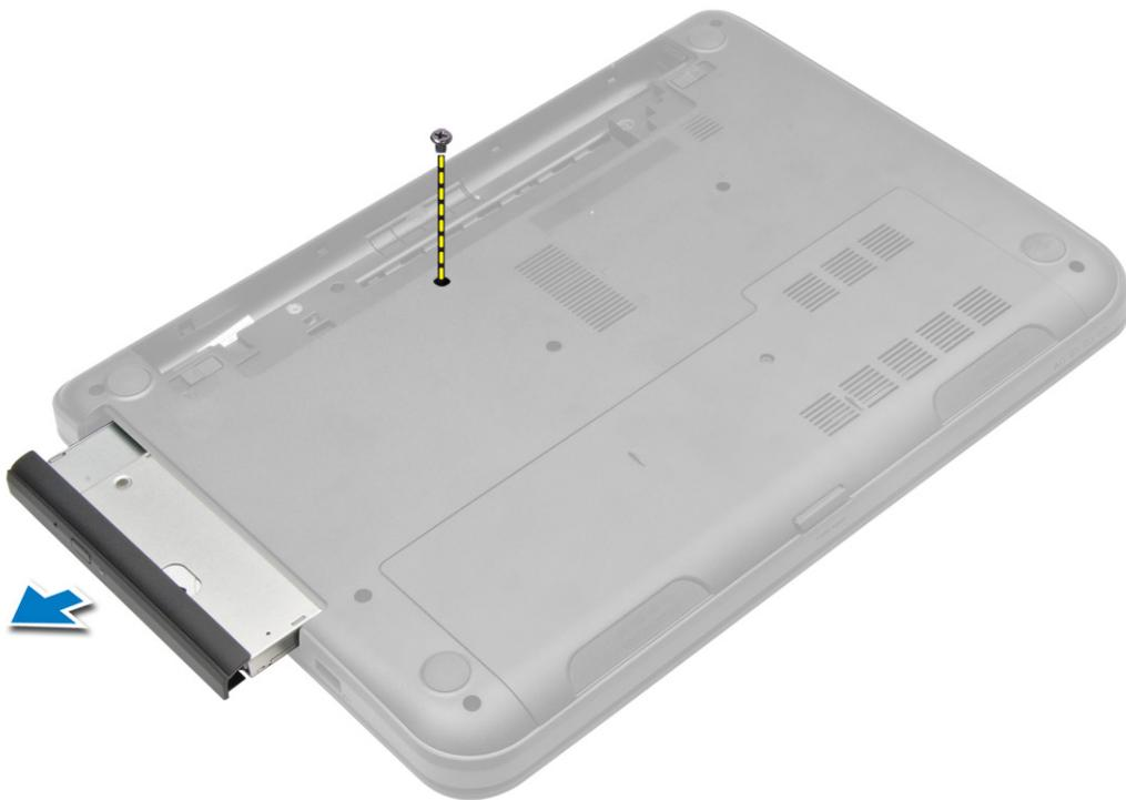
4. Retire o parafuso que fixa o suporte da unidade óptica à respectiva unidade e retire-o.
