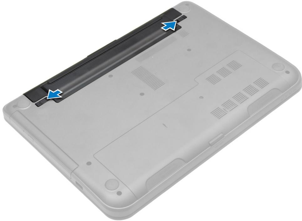
3. Levante a bateria para removê-la do computador.
