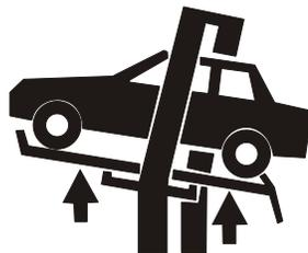
Adaptadores auxiliares podem reduzir a capacidade de carga.
