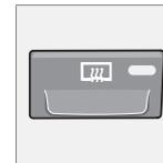
O aquecimento é utilizado para desembaciador ou eliminar gelo rapidamente do vidro traseiro e dos retrovisores exteriores. Pressionando uma vez o botão inicia-se simultaneamente o aquecimento do
