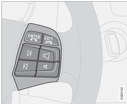
Os quatro botões inferiores na unidade de botões no volante são comuns para o rádio e o telefone. A função dos botões depende do sistema que está activado. Com a unidade de botões no volante pode-se alternar entre as estações previamente programadas, mudar de faixa no CD e regular o volume.
