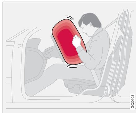
Em complemento ao cinto de segurança no lado do condutor, o automóvel está equipado com um airbag, SRS (Supplemental Restraint System). O airbag encontra-se acondicionado no centro do volante. O volante está marcado com o texto **SRS AIRBAG**.
