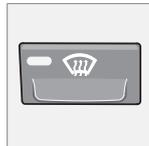
Para remover de forma rápida a condensação e o gelo do pára-brisas e dos vidros laterais. O ar flui para os vidros com elevada velocidade do ventilador. A lâmpada no botão do desembaciador fica
