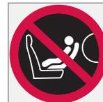
*Autocolante colocado na extremidade do tablier.*
