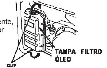
Use somente água com sabão ou solvente não inflamável para limpar o elemento filtrante. Gasolina ou solventes inflamáveis podem causar explosão e incêndio.
