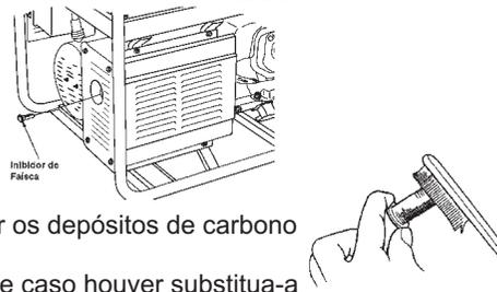
Utilize uma escova para remover os depósitos de carbono da tela do inibidor de faísca. Veja se existem buracos na tela e caso houver substitua-a.
