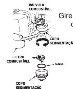
Gire o registro do combustível para a posição OFF, remova o copo de sedimentação, e o o-ring, limpe o copo de sedimentação, e o o-ring em solvente não inflamável, reinstale o o-ring e o copo de sedimentação, coloque o registro de combustível na posição ON e veja se não há vazamentos.
