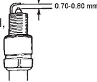
Certifique que a arruela da vela está em boas condições, e coloque a vela com cuidado utilizando a mão para que ela não entre atravessada e nem espante a rosca, depois que estiver bem colocada, utilize a chave para apertar bem a vela e comprimir a arruela.
