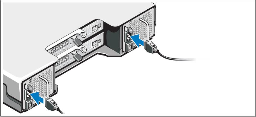
Asegúrese de que el conmutador de alimentación esté en la posición de APAGADO antes de conectar los cables de alimentación. Conecte los cables de alimentación del sistema al sistema.
