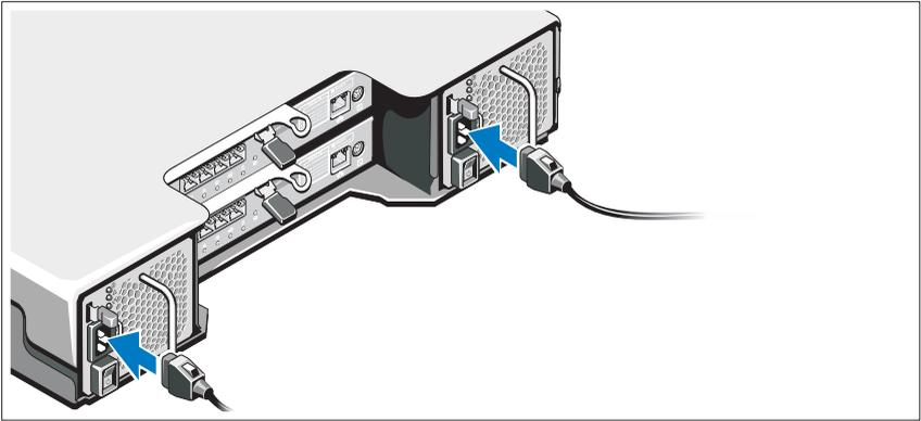
Verifique se a chave está na posição “desligada” (OFF), antes de conectar os cabos de alimentação. Conecte o(s) cabos de alimentação ao sistema.
