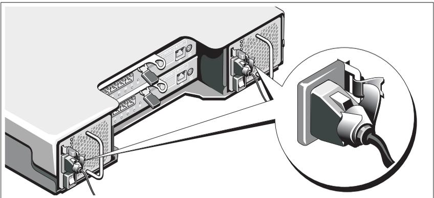
Fixez fermement les câbles au support de fixation à l'aide de la lanière fournie. Branchez ensuite l'autre extrémité des câbles d'alimentation sur une prise de courant mise à la masse ou sur une source d'alimentation autonome (onduleur [UPS] ou unité de distribution de l'alimentation [PDU]...). Chaque bloc d'alimentation doit être connecté à un circuit d'alimentation différent.
