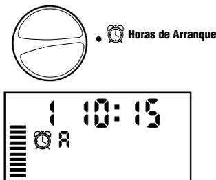
**OBSERVAÇÃO:** Uma hora de arranque activará todas as estações seqüencialmente, para um determinado programa. Isto elimina a necessidade de programar a hora de arranque de cada estação. Múltiplas horas de arranque em um programa, podem ser usadas para regas separadas pela manhã, tarde ou noite. As horas de arranque podem ser programadas em qualquer ordem. O X-Core vai ordená-las automaticamente.
