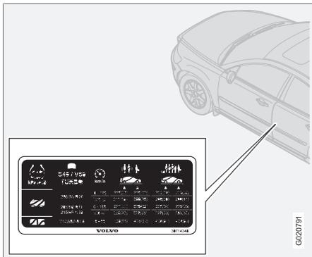
O autocolante da pressão dos pneus no pilar da porta do lado do condutor indica as pressões correctas dos pneus para diferentes condições de carga e velocidades.
