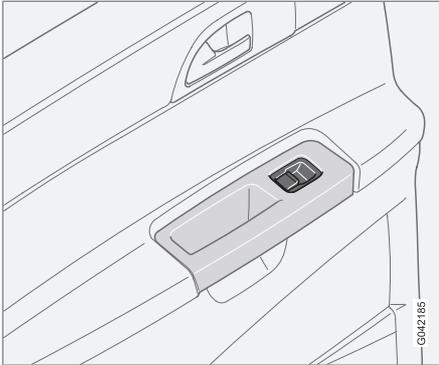
Os vidros das portas traseiras podem ser accionados pelos comandos nas portas respectivas ou pelo interruptor na porta do condutor. Se a lâmpada do interruptor de bloqueio dos vidros eléctricos das portas traseiras (colocado no painel de comando na porta do condutor) estiver aceso, os vidros das portas traseiras só podem ser accionados a partir da porta do condutor. Os vidros das portas traseiras são accionados da mesma forma que os vidros nas portas dianteiras.
