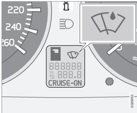
O sensor de chuva detecta a quantidade de água no pára-brisas e activa automaticamente os limpa pára-brisas. A sensibilidade do sen-
