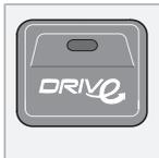
Em algumas situações pode ser desejável desactivar temporariamente a função Start/Stop automático - esta acção pode ser realizada com uma pressão no botão, apagando-se a lâmpada do
