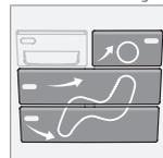
O fluxo de ar pode ser distribuído para os vidros, para as aberturas de ventilação no tablier ou para o chão, carregando-se nos botões de distribuição de ar.
