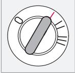
Bloqueio do volante desactivado. Podem ser utilizadas algumas funções. O sistema eléctrico do motor não está ligado.
