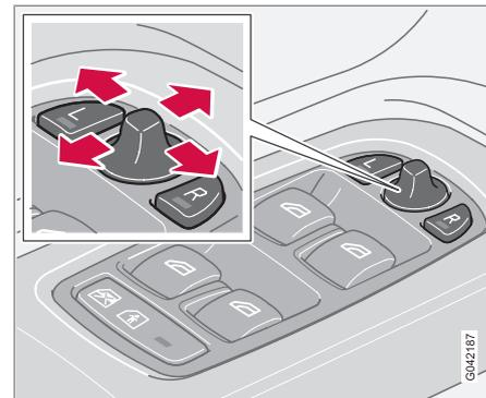
O comando para o ajuste dos dois espelhos retrovisores exteriores encontra-se na parte da frente do descanso do braço da porta do condutor. Os espelhos retrovisores podem ser accionados na posição de chave I e II.
