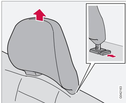
Todos os encostos de cabeça são reguláveis na vertical para se ajustarem à altura dos passageiros. A parte superior do encosto deve ser ajustada para o meio da nuca. Desloque o encosto de cabeça para cima consoante o necessário.
