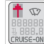
GSI - Gear Shift Indicator - indica ao condutor quando é vantajoso proceder a uma mudança. A indicação é feita através de uma seta para passagem ascendente ou descendente no mostrador de
