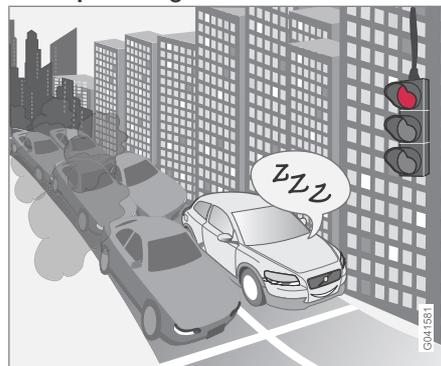
Além de estar equipado com um motor Diesel seguro e económico, este automóvel possui uma função de Arranque e Paragem que entra em funcionamento, por exemplo, em filas de trânsito ou esperas em semáforos - ver descrição detalhada na próxima página.
