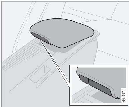
Sob o descanso de braço existe um compartimento de arrumação. Também existe um pequeno compartimento de arrumação no descanso de braço amovível. Pressione o botão mais pequeno e levante o descanso de braço para abrir o compartimento mais elevado. Pressione o botão maior e levante o descanso de braço para abrir o compartimento mais profundo.
