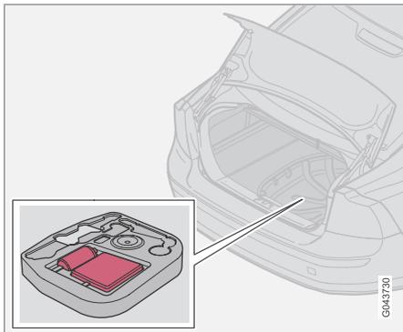
O kit de reparação de emergência de pneus furados é utilizado tanto para selar os furos como para verificar e ajustar a pressão dos pneus. Este consiste num compressor e num depósito com o vedante. O kit funciona como reparação provisória. A garrafa com o líquido vedante deve ser substituída antes de terminado o prazo de validade e após a sua utilização.
