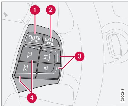
Quando o telefone está activado, a unidade de botões do volante comanda apenas as funções do telefone. Para que comande o equipamento de áudio o telefone tem que estar em modo de espera (standby).
