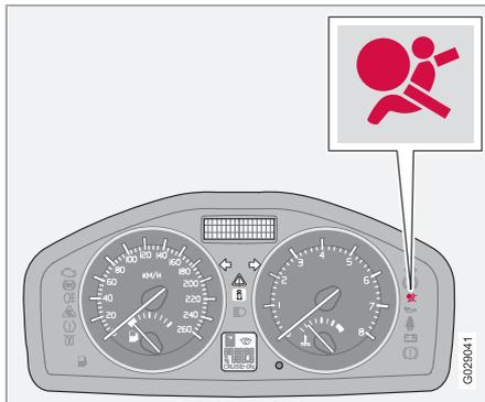
O símbolo de aviso do painel de instrumentos acende-se quando se roda o comando à distância para a posição de ignição I, II ou III. O símbolo apaga-se passados cerca de 6 segundos, caso o sistema Airbag não tenha qualquer anomalia.
