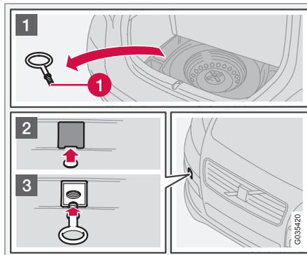
O olhal de reboque é apertado numa entrada roscada atrás de uma tampa de cobertura no lado direito do pára-choques, dianteiro ou traseiro.
