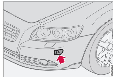
Entrada eléctrica para o aquecedor do bloco do motor.
