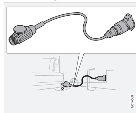
Se o engate de reboque do automóvel tiver um conector eléctrico com 13 pinos e o atrelado tiver um conector de 7 pinos, é necessário um adaptador. Utilize um cabo adaptador aprovado pela Volvo. Certifique-se de que o cabo não arrasta no chão.
