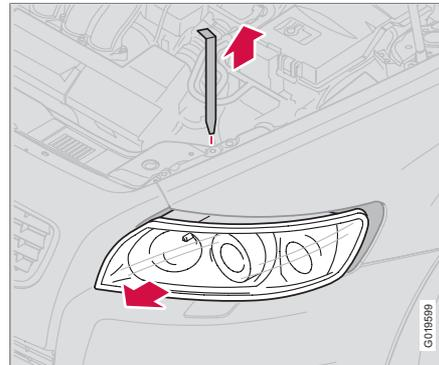
Todas as lâmpadas incandescentes dianteiras (à excepção das luzes de nevoeiro) são mudadas por meio de, através do compartimento do motor, soltar e desmontar o cárter da unidade das luzes.
