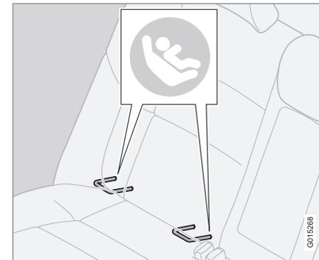
Os pontos de fixação ISOFIX encontram-se dissimulados atrás da parte inferior das costas do banco traseiro, nos lugares exteriores.
