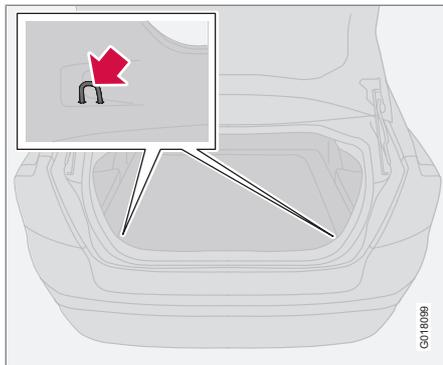
Os olhais de fixação de carga são utilizados para prender as cintas de retenção ou redes para proteger a carga no compartimento da bagagem.
