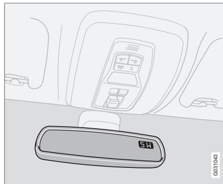
O canto superior direito do retrovisor interior tem um visor integrado que mostra a direcção da bússola para onde a frente do automóvel está a apontar. São indicadas oito direcções diferentes com abreviaturas inglesas: **N** (Norte), **NE** (Nordeste), **E** (Este), **SE** (Sudeste), **S** (Sul), **SW** (Sudoeste), **W** (Oeste) e **NW** (Noroeste).
