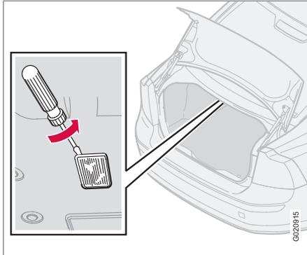
1. Introduzir uma chave de fendas e rodar ligeiramente para desmontar o cárter das lâmpadas.
