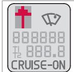
O condutor possui um indicador auxiliar que informa quando é vantajoso engatar a mudança superior ou inferior - GSI (Gear Shift Indicator).
