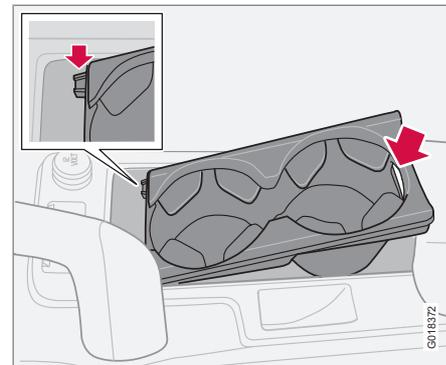
Sob a gelosia existe compartimento para um porta-canecas duplo. O compartimento pode ser utilizado para arrumos, para tal basta levantar o porta-canecas. Levante o porta-canecas na margem traseira, onde existe uma reentrância.
