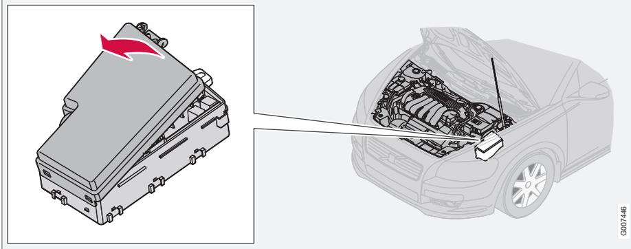
Existem 36 posições de fusíveis. Tenha o cuidado de substituir um fusível queimado por um novo que tenha a mesma cor e a mesma amperagem.
