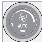
A função **AUTO** regula o comando da climatização automaticamente de modo a atingir a temperatura seleccionada. O modo automático controla o aquecimento, o ar condicionado, a velocidade do ventilador, a recirculação e a distribuição de ar.
