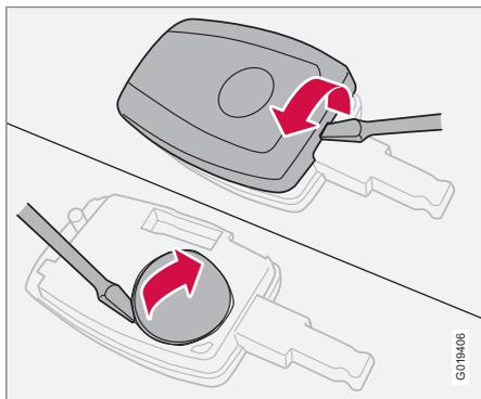
Se as fechaduras não reagirem várias vezes seguidas aos sinais do comando à distância a uma distância normal, a bateria deve ser substituída (tipo CR 2450, 3 V).
