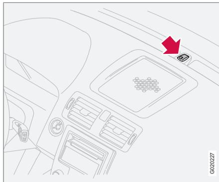
Um LED vermelho na parte de cima do tablier mostra o estado do sistema de alarme:
