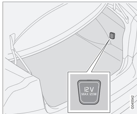
Dobre a tampa para baixo para aceder à tomada eléctrica. Esta funciona independentemente de a ignição estar ligada ou não.
