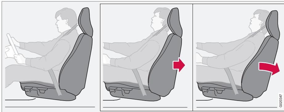
O sistema WHIPS (Whiplash Protection System) é composto por costas do banco que absorvem a força de impacto e por apoios de cabeça especialmente desenvolvidos em ambos os bancos dianteiros. O sistema é activado em caso de colisão traseira, dependendo do ângulo, da velocidade de colisão e das características dos veículos que chocam.
