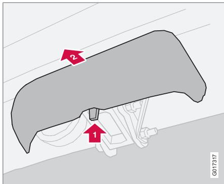
1. Retire a capa protectora pressionando o fecho **1** e, de seguida, puxando a capa para trás **2**.
