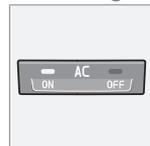
**ON:** O sistema de ar condicionado está ligado. O sistema é comandado automaticamente. Deste modo, o ar que entra é arrefecido e desumidificado.
