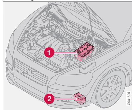
1. Bateria de arranque<sup>2</sup> 2. Bateria de apoio.
