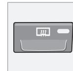
O aquecimento é utilizado para desembaciador ou eliminar gelo rapidamente do vidro traseiro e dos retrovisores exteriores. Pressionando uma vez o botão inicia-se simultaneamente o aquecimento do
