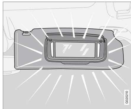
A lâmpada acende-se e apaga-se automaticamente quando a tampa abre ou fecha.
