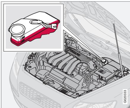
O líquido de travões e da embraiagem tem um reservatório em comum<sup>5</sup>. O nível deve estar entre as marcações **MIN** e **MAX**. Controlar o nível com regularidade. Mude o líquido dos travões cada dois anos ou após cada duas ocasiões normais de serviço de manutenção.
