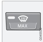
Para remover de forma rápida a condensação e o gelo do pára-brisas e dos vidros laterais. O ar flui para os vidros com elevada velocidade do ventilador. A lâmpada no botão do desembaciador fica
