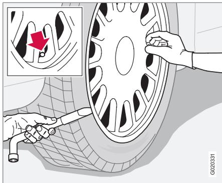
Coloque o triângulo de sinalização de perigo se tiver de substituir uma roda numa zona de trânsito. Assegure-se de que o automóvel e o macaco encontram-se sobre um plano horizontal e firme.
