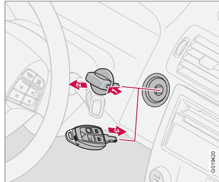
Se não for possível desligar o alarme com o comando à distância - por ex: com a bateria gasta - o automóvel pode ser destrancado, o alarme desligado e o motor arrancado do seguinte modo:
