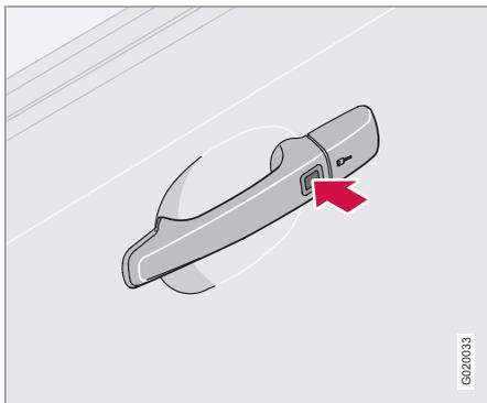
Automóveis com sistema de Condução sem Chave possuem um botão no puxador exterior das portas.
