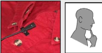
**Melhor prática:** Siga a “Regra dos Dedos Indicador e Polegar” para posicionar um microfone de lapela em um apresentador. Quando se coloca o dedo indicador no queixo e o polegar voltado para a garganta, a posição do polegar indica a localização apropriada onde o microfone deve ser fixado.
