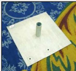
As bases de apoio são feitas de aço sólido e pesam cerca de 15 quilogramas cada, possuem 60cm de cada lado e 6,5mm de espessura. Existe um pequeno buraco no centro no qual um pino é afixado. Este suporte de metal mantém a haste em pé e evita que a montagem caia.
