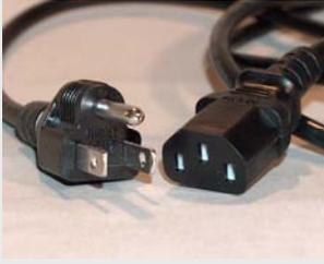
O conector macho é a terminação final do cabo de energia.
