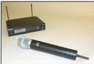
Receptor e microfone portátil com transmissor
