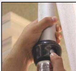
As hastes ocas de alumínio possuem um anel de pressão de metal usado para ajustar a altura da haste. À medida que você eleva a haste, o anel de pressão a mantém na nova altura ajustada.
