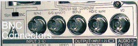
Usado para transportar muitos tipos diferentes de sinais como frequência de radio, vídeo componente, código temporal, sincronismo e energia.
