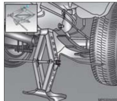
8. Posicione o ressalto da base superior do macaco (seta) no encaixe próximo da roda a ser substituída.
