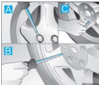
6. Remova as coberturas dos parafusos (A) ou calota central (B/C) com a chave (A e B).
