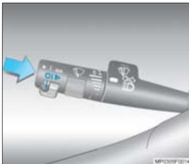
3. Pressione a tecla SET-AJUSTAR na extremidade da alavanca e solte-a.
