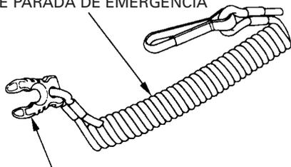
PLACA DE TRAVA DO INTERRUPTOR DE PARADA DE EMERGÊNCIA
