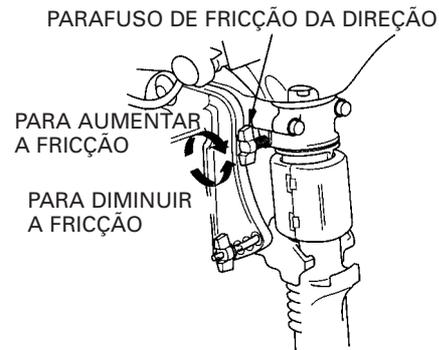
Para uma direção suave, ajuste o parafuso de fricção de forma que haja uma pequena resistência ao esterçar.
