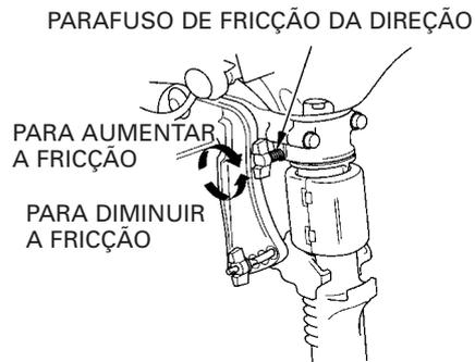
Este parafuso de fricção ajusta da resistência da direção.
