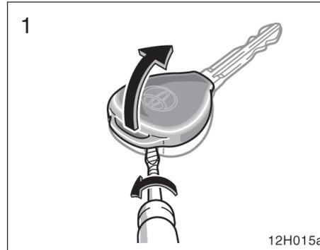
1. Abra a tampa usando uma chave de fenda apropriada envolta em fita plástica.
