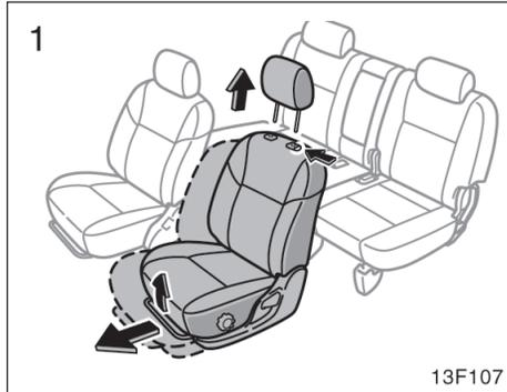
1. Remova o apoio de cabeça dianteiro. Deslize o banco dianteiro o máximo possível para frente para travar o banco.
