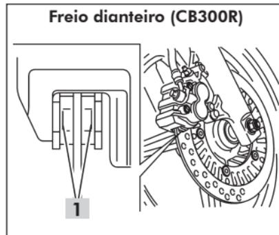
2. Adicione fluido, se necessário. Se o nível estiver baixo, inspecione também o desgaste das pastilhas (págs. 6-19 e 6-20). Se estiverem em bom estado, verifique se há vazamentos.
