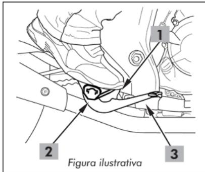
**Pés:** afaste a ponta dos pés (1) dos pedais de apoio (2) para que não haja o acionamento desnecessário dos pedais do freio e câmbio (3). Especificamente em curvas, evite manter as pontas dos pés para fora ou abaixo dos pedais de apoio, pois isso pode acarretar contato com o solo.
