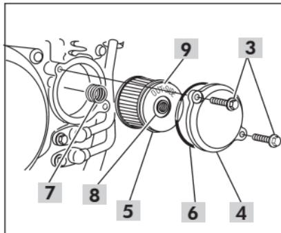
3. Remova os parafusos do filtro de óleo (3) e a tampa do filtro (4). Em seguida, retire o filtro de óleo (5) da tampa.
