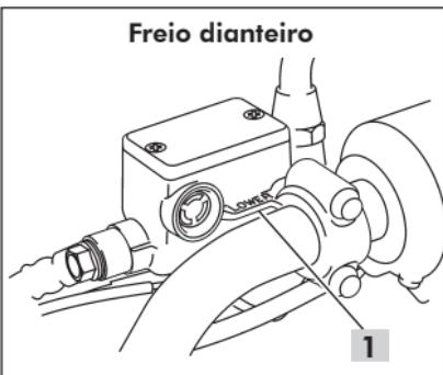
1. Com a motocicleta na vertical, verifique se o nível de fluido no reservatório está acima da marca de nível inferior **(1)** (freio dianteiro) ou entre as marcas de nível superior **(2)** e inferior **(3)** (freio traseiro).
