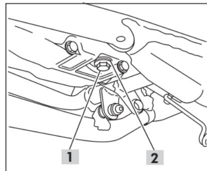
1. Coloque um recipiente sob o motor para coletar o óleo e remova a tampa/vareta medidora, o bujão de drenagem (1) e a arruela de vedação (2).
