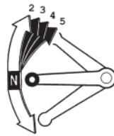
Cada toque no pedal muda para a marcha seguinte, em sequência. O pedal retorna automaticamente para a posição horizontal quando solto.
