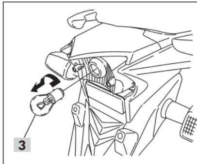
3. Instale a nova lâmpada na ordem inversa da remoção.
