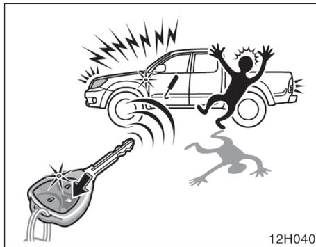
**Pressionar o interruptor de alarme por 2 segundos ou mais faz soar o alarme de segurança e a buzina do veículo intermitentemente e piscar as luzes indicadoras de direção.**
