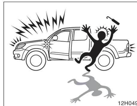
O sistema de alarme anti-furto foi projetado para impedir o roubo do veículo. O sistema fará com que as luzes indicadoras de direção pisquem, e o alarme e buzina sejam acionados quando for detectada alguma anormalidade como:
