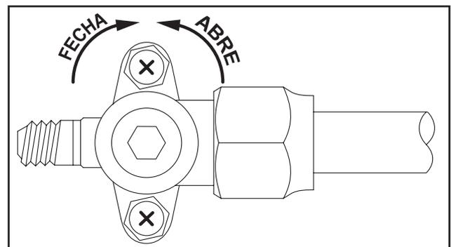
FIG. 25 - VÁLVULA DE SERVIÇO SEM PORCA DE PROTEÇÃO
