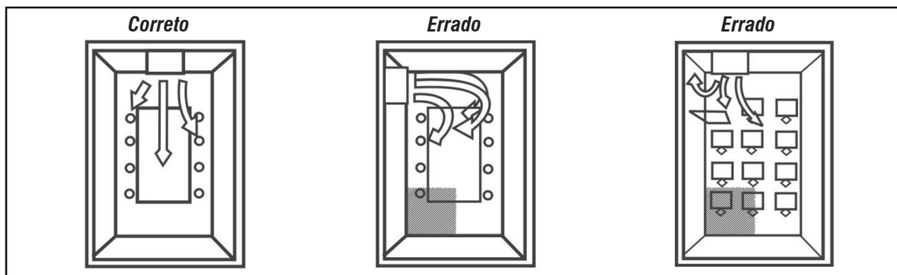
FIG. 12 - POSICIONAMENTO DA UNIDADE EVAPORADORA NO AMBIENTE
