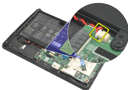
7. Solte o cabo da bateria de célula tipo moeda e remova-a do computador.
