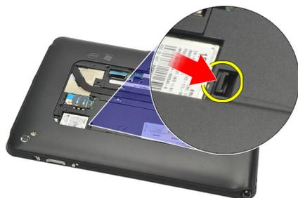
5. Retire e libere as abas que prendem a tampa inferior seguindo a sequência de seta no diagrama.
