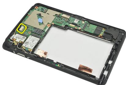
8. Destaque o cabo da câmera de sua fixação adesiva à placa de sistema.
