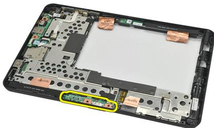
9. Retire a fita que prende a placa de acoplamento.
