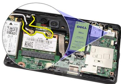
6. Remova o parafuso que prende a placa WLAN.
