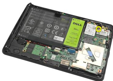
7. Remova a placa WLAN do computador.
