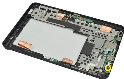
9. Levante a placa de E/S e remova-a do computador.
