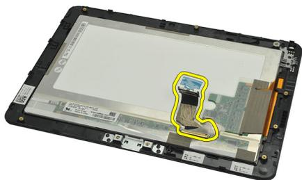
O diagrama a seguir mostra o conjunto do painel da tela após a remoção de todos os componentes do computador na ordem listada acima.
