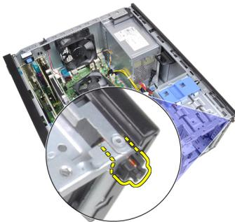
9. Deslize o cabo do interruptor de alimentação para fora através da parte frontal do computador.
