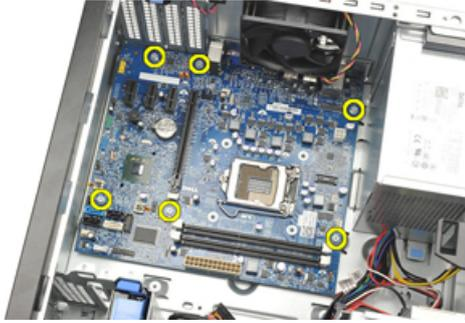
8. Faça deslizar a placa de sistema em direcção à parte anterior do computador.
