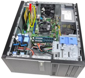
6. Levante a placa de expansão PCI (se existir) para fora do respectivo conector e retire-a do computador.
