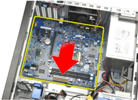
9. Com cuidado, incline a placa de sistema num ângulo de 45 graus e depois retire-a do computador.
