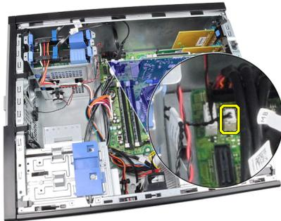
4. Retire o cabo do sensor térmico do grampo no chassis.
