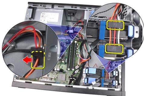
4. Retire os cabos de alimentação dos grampos no computador.
