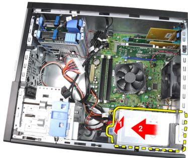
9. Levante a fonte de alimentação e retire-a do computador.
