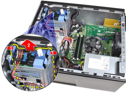
5. Fluta o suporte da unidade de disco rígido e depois retire a unidade do suporte.
