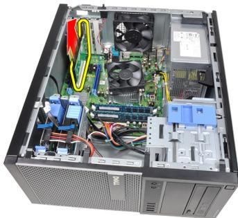
7. Levante a placa de expansão PCI x4 (se existir) para fora do respectivo conector e retire-a do computador.
