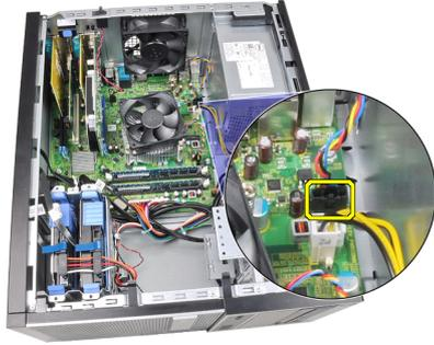
4. Levante a ventoinha do sistema e retire-a dos quatro ilhoses que fixam a ventoinha à parte posterior do computador.
