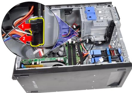
5. Deslize para baixo o trinco da unidade óptica e depois empurre a unidade da parte posterior para a parte anterior do computador.
