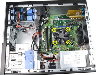
5. Levante o conjunto do dissipador de calor e retire-o do computador. Coloque o conjunto com a ventoinha voltada para baixo e com a massa térmica para cima.
