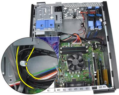
6. Retire o parafuso que fixa o painel de entrada/saída ao computador.
