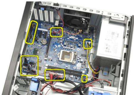
7. Retire os parafusos que fixam a placa de sistema ao computador.
