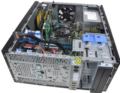
7. Faça deslizar o painel de entrada/saída para o lado esquerdo e solte-o.
