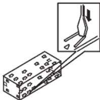
3. Conecte o chicote do seu veículo no MM830. Conecte, também, a antena do seu veículo. Em seguida, insira o MM830 no painel do seu veículo até que ele fique travado na cinta metálica.
