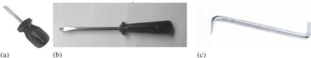
Figura 9. Chaves de fenda: a) Cotoco b) fenda simples e c) fenda angular dupla.
