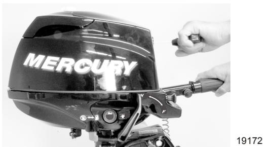
10. Verifique se um fluxo contínuo de água está saindo pelo furo indicador da bomba de água.
