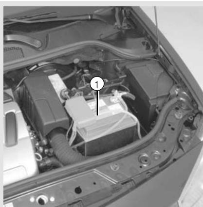
Esta bateria não necessita de manutenção; nunca abra a tampa **1**.
