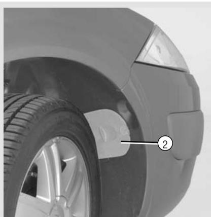
Com o motor desligado, gire o obturador **1** um quarto de volta (no sentido contrário ao dos ponteiros do relógio).
