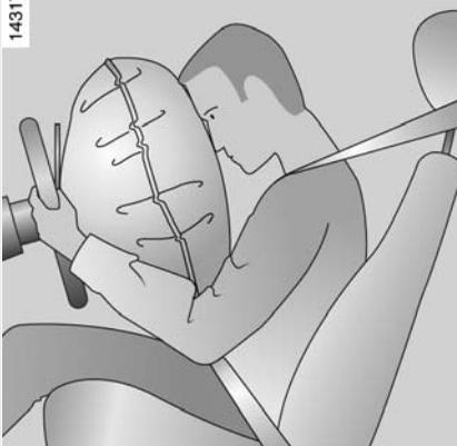
Quando há um impacto violento (do tipo frontal) e o veículo atinge um determinado limite de desaceleração, as bolsas enchem-se com gás (em cerca de 0,03 segundos), provocando o amortecimento do impacto da cabeça do condutor sobre o volante e o amortecimento do impacto da cabeça do passageiro sobre o painel de bordo, esvaziando-se logo em seguida, a fim de evitar qualquer dificuldade para sair do veículo.
