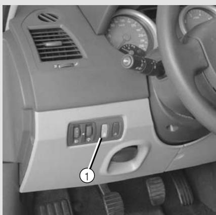
O limitador de velocidade é uma função que permite decidir a que velocidade máxima se pretende circular.
