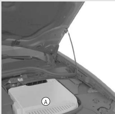
Conforme a versão do veículo, a bateria pode estar protegida por uma tampa **A**, que deve ser retirada com o auxílio de ferramentas específicas.
