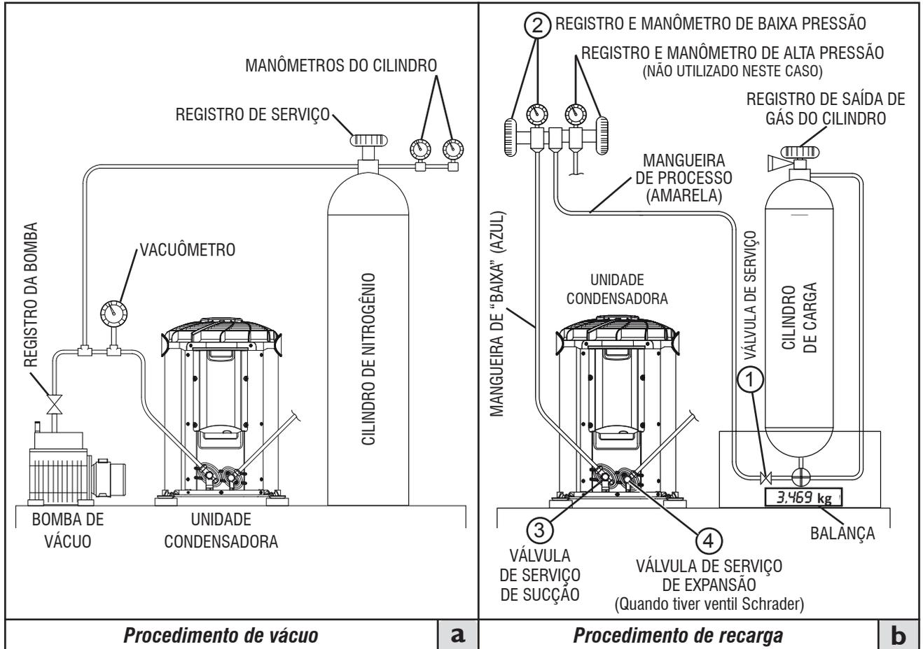
FIG. 37 - PROCEDIMENTOS DE VÁCUO E RECARGA
