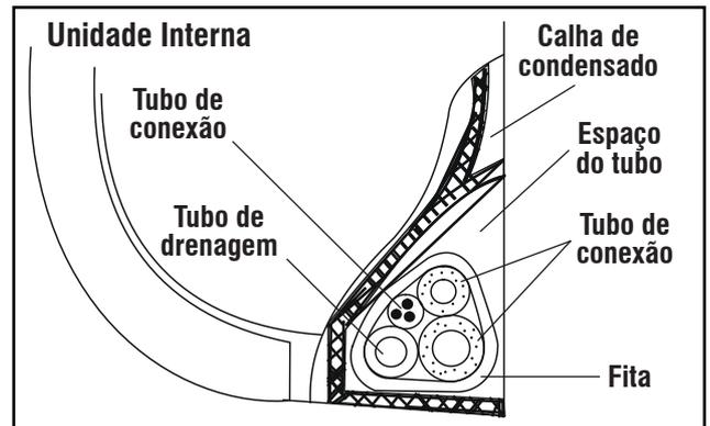
FIG. 16 - TUBO DE CONEXÕES
