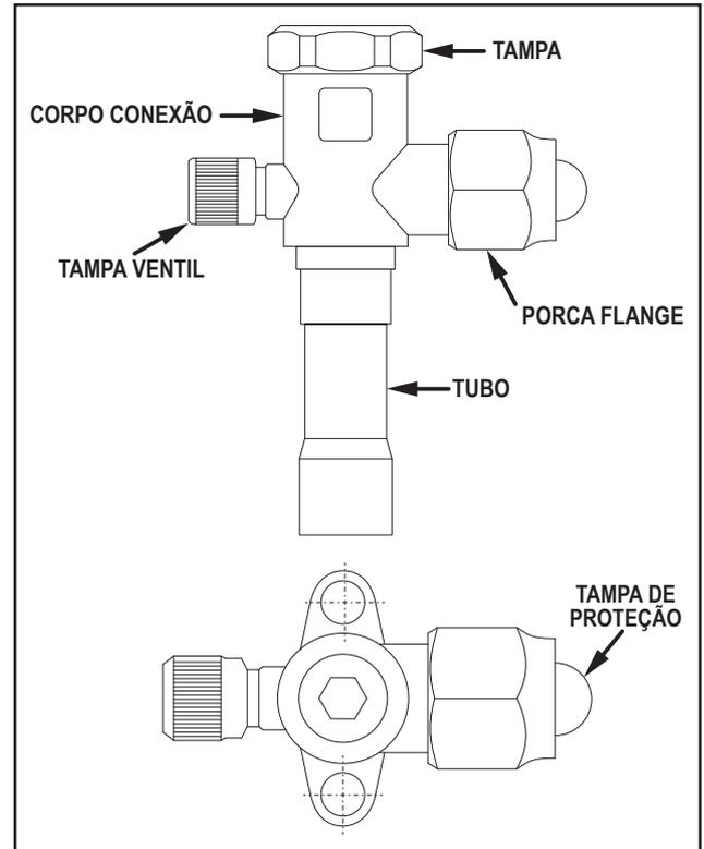
FIG. 24 - VÁLVULA DE SERVIÇO LINHAS SUÇÃO/EXPANSÃO
