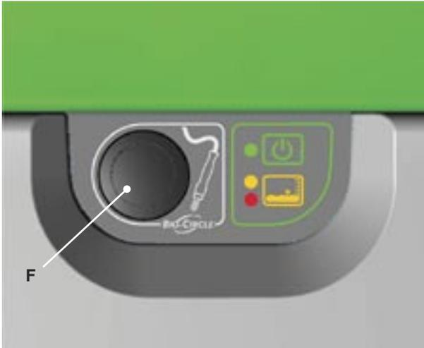
5. O processo de bioremediação requer um ambiente favorável por todo o tempo, até mesmo quando a unidade não estiver em uso. **Mantenha sempre o nível solução próximo ao máximo e a máquina ligada** a fim de manter a temperatura adequada e a provisão de oxigênio através da aeração.
