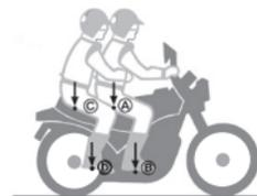
Distribua a soma dos pesos uniformemente entre A (assento dianteiro), B (pedal de apoio dianteiro), C (assento traseiro) e D (pedal de apoio traseiro).
