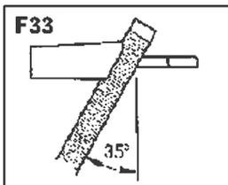
3. Lime até que a parte superior e o lado curvo do dente de corte estejam afiados sem que fiquem rebarbas. Procure limar todos os dentes na mesma proporção para que haja um desgaste uniforme da corrente de corte.
