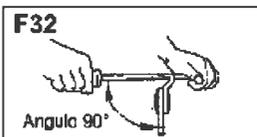
2. Mantenha a lima em posição horizontal, formando um ângulo de 90° com a barra. Lime empurrando-a para frente, voltando sem afiar, e então lima novamente apenas para a frente. (Fig.32)
