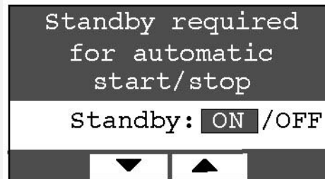
FIGURA 10. TELA HABILITAR/DESABILITAR A EMERGÊNCIA (STANDBY)
