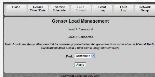
FIGURA 31. GERENCIAMENTO DE CARGAS DO GRUPO GERADOR
