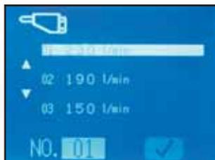
Ecrã de ajustamento geral de fluxo hidráulico em modo B (martelo)
